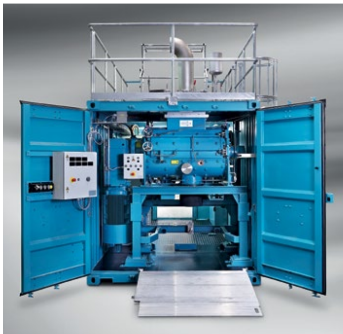
Abb.: Der mobile Pflugscharmischer in the Box ermöglicht Verschleißuntersuchungen vor Ort
