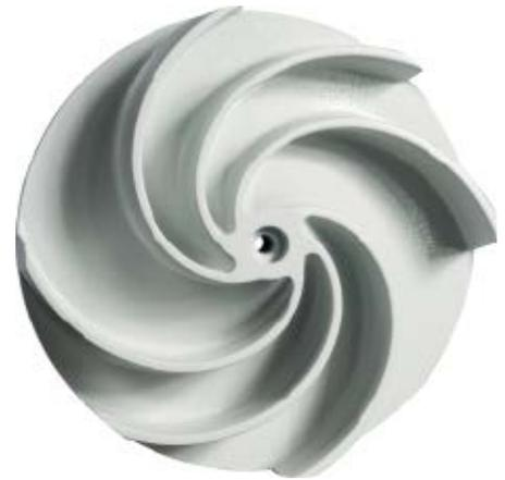
**Abb. 4:** Dank asymmetrischer Schaufelanordnung können Feststoffe unterschiedlicher Größe das neue Fmax-Laufrad problemlos passieren.
