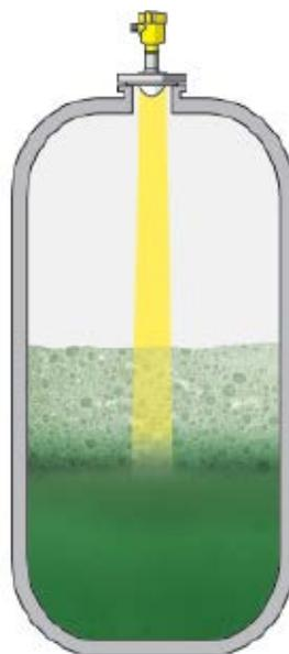
Abb. 4: Auch bei Schaum, extrem turbulenten Füllgutoberflächen, Kondensat und Anhaftungen ermöglicht der Vegapuls 64 eine zuverlässige Messung.
