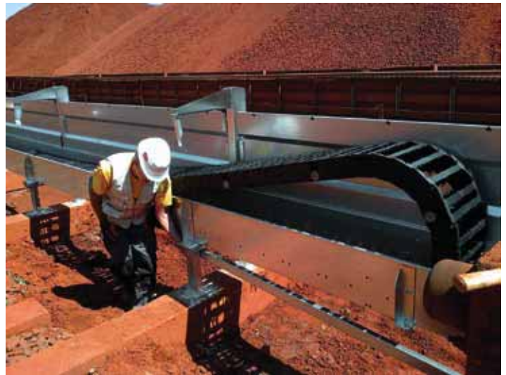
Abb. 2: Die Ausführung als Rollenkette minimiert die auftretenden Zug-/Schubkräfte, außenliegende Radiusanschlänge verhindern ein Festsetzen des Förderguts an den sich bewegenden Teilen.
