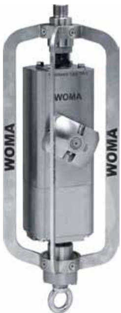
Abb. 4: Für den Einsatz in explosionsgefährdeten Bereichen müssen Innenreinigungsköpfe eingesetzt werden, die nach der Explosionschutzrichtlinie ATEX zertifiziert sind. Dieses Modell ist bei Zone 0 bis 500 bar einsetzbar.
