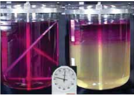
Abb. 1: Vergleich der Durchmischung bei Ekato Paravisc (li) und Ankerrührer (re).
