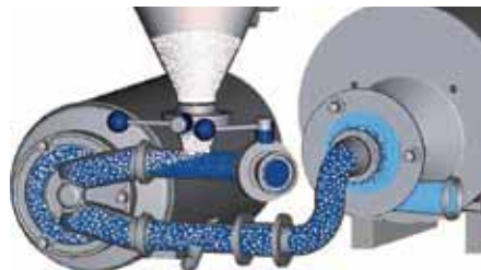
Abb. 2: Das Pulver wird über einen Zuführtrichter in den flüssigen Produktstrom eingesaugt und mit Hilfe der Shearpump homogenisiert
