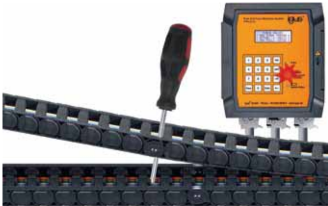
Abb. 3: Sicherheit geht vor: Ein PPDS-System überwacht kontinuierlich die auftretenden Zug- und Schubkräfte der Energiekette. Bei Unregelmäßigkeiten wird ein Abschalten der Bewegung veranlasst.
