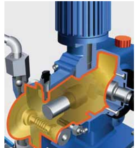
Abb. 3: Das gemeinsame Ölbad für Antriebseinheit und Pumpenkopf macht die Instandhaltung für den Betreiber einfach.
