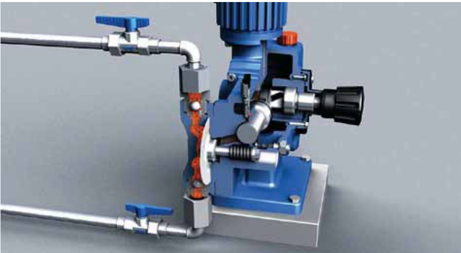
Abb. 2: Eine Kontamination des Prozessfluids ist dank der doppellagigen Membran nicht zu befürchten.
