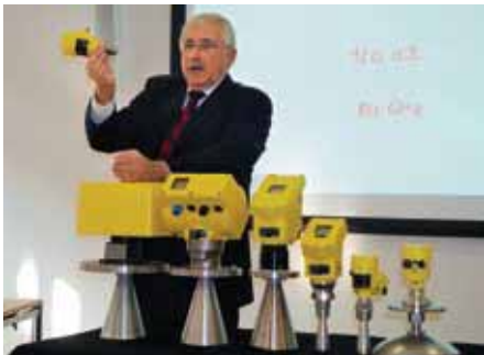
Abb. 1: So ändern sich die Zeiten auch für die Radar-Füllstandmessung: Was im Jahr 1991 noch kaum in einen Seesack gepasst hätte (links), lässt sich heute in die Jackettasche von Geschäftsführer Günter Kech stecken – bei gleichzeitig deutlich besserer Performance.
