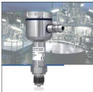
durch Schweißen hermetisch dicht verschlossen. Eine Diffusion des Messmediums in das System oder der Übertragungsflüssigkeit aus dem System ist nicht möglich. Die Messumformer der DMU 02 Vario Serie eignen sich zur elektronischen Druckmessung in den Messbereichen -1/0 bar bis 0/600 bar. Sie vertragen Mediums-Temperaturen von -10 bis 125 °C und liefern 4–20 mA oder 0-10 V Ausgangssignale.
