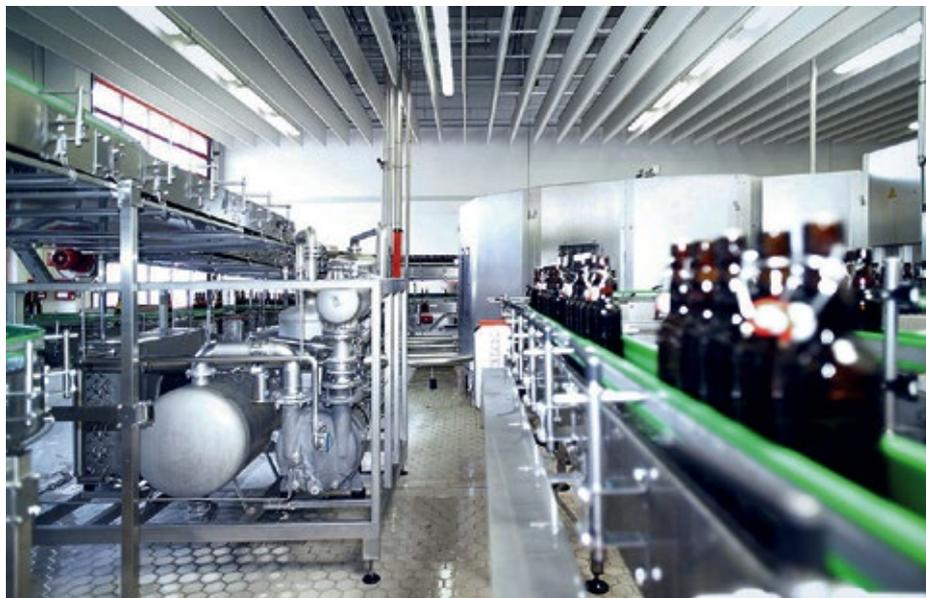
**Abb. 1:** Wassersparende Vakuumtechnik in der Getränkeabfüllung mit L-BL2-Aggregat.
