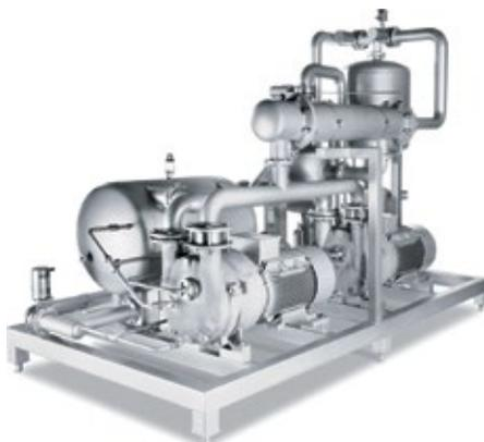
**Abb. 3:** Die komplett in Edelstahl ausgeführte L-BL Vakuumanlage mit patentierter Abluftkühlung, Zweikammer-Vorabscheider und CIP-Verrohrung.
