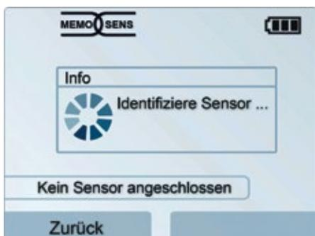
Abb. 1: Die Memosens-Technologie macht's möglich: automatische Sensorerkennung einschließlich der im Sensorkopf hinterlegten Kenndaten.
