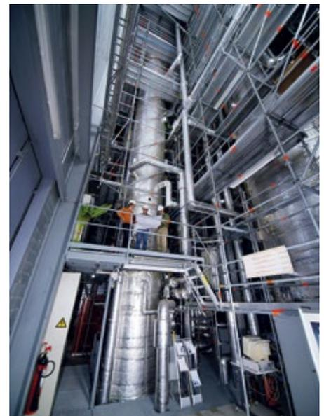
Abb. 4: Panda ist modular aufgebaut. Dadurch kann für wechselnde Applikationen das Verhalten von Druckkesseln, Wasserbecken oder Kondensatoren nachgestellt und systematisch untersucht werden.
