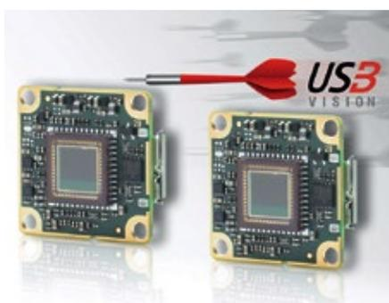
mit der manuell anpassbaren ROI kann die Frame-rate noch gesteigert werden. Die dart Boardlevel Kameras eignen sich für Anwendungen in Automation, Mikroskopie, intelligenten Verkehrssystemen (ITS) und sind ideal für den Einsatz in Robotik Vision Anwendungen.
