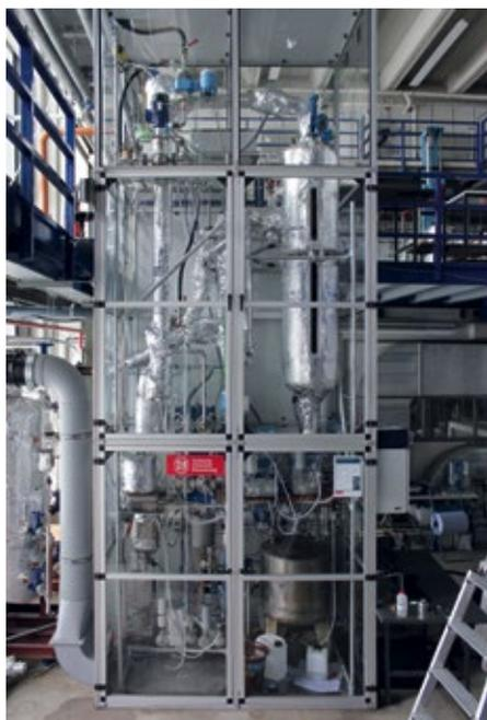
Abb. 1: Versuchsstand mit Glattrohrkondensator an der TU Braunschweig
