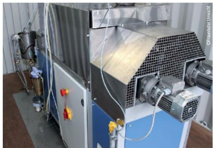
Abb. 3: Die TCR-Anlage wird im Rahmen eines Forschungsprojektes zur Rückgewinnung von Phosphor aus Klärschlamm eingesetzt.
