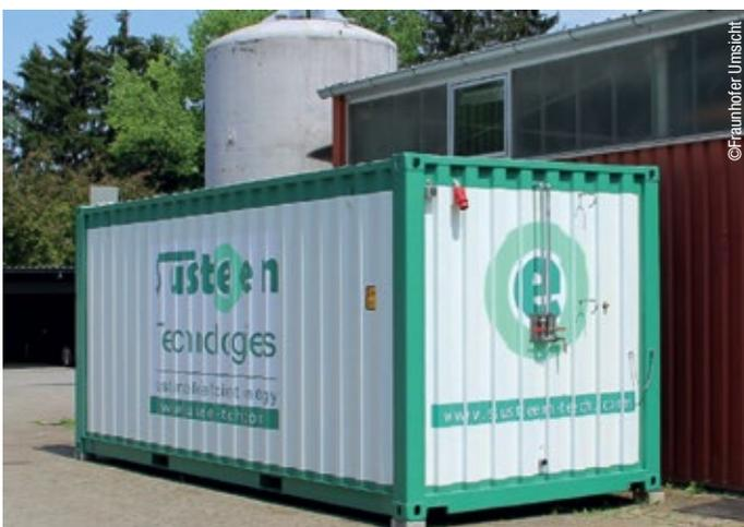
Abb. 2: Die TCR-Anlagen von Susteen Technologies werden in Containern direkt an ihren Einsatzort geliefert und dort in Betrieb genommen.
