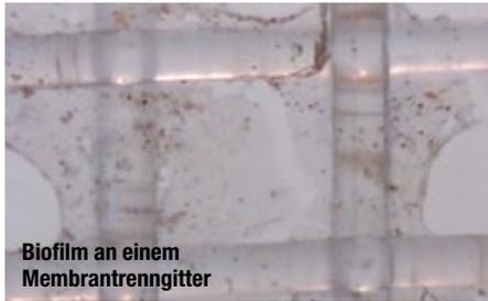
**Biofilm an einem Membrantrenngitter**
