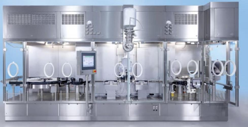
**AFG 5000 Füll- und Verschließmaschine für die präzise und zuverlässige Pulververarbeitung**
