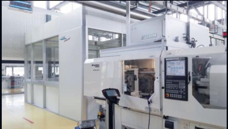
Abb. 1: Reinraumlösung mit angedockter Spritzgießmaschine.
