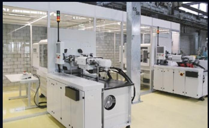
Abb. 3: Die Spritzgiesseinheiten mit den hohen Wärmelasten bleiben ausserhalb des vollverglasten Reinraums.
