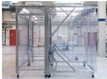
**Abb. 2: Drei separate Reinraumeinheiten, die zu einem einzelnen Raum verbunden werden können**
