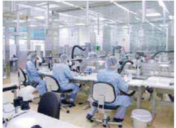
**Einst und heute, Teil 1: Arbeitsplätze, an denen die Funktion der Elektroden von Gehörimplantaten getestet wird – inzwischen im Reinraum und in RR-Schutzkleidung.**
