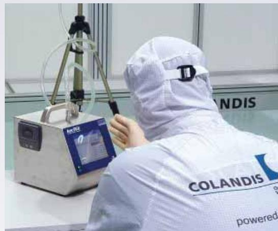
Abb. 2: Einmessen des mobilen Testreinraums
