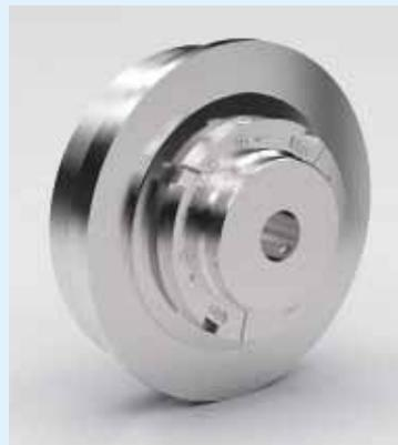
Innen (Tellerfeder) wie außen, ist die ECR komplett aus rostfreiem Edelstahl gefertigt und die Rastkugeln sind mit einer Lebensdauerschmierung entsprechend der NSF-Registrierung versehen, so dass sich diese Type mit vier Baugrößen und Einstellbereichen von 50–240 Nm bestens für Reinräume in der Medizin- und Pharmaindustrie sowie die Lebensmittelbranche eignet.
