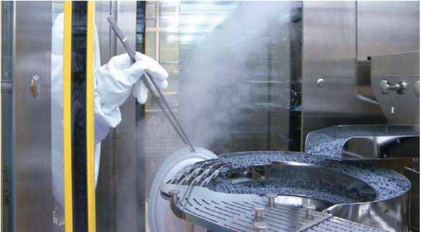
Abb. 3: Typische Kameraeinstellung am Stopfentopf innerhalb eines Isolators
