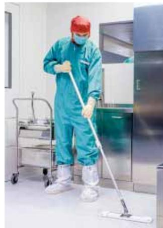
Spezielle Reinraum-Mops aus reinraumgeeigneten Mikrofilamenten sind ein wichtiges Werkzeug bei der Arbeit des Fachpersonals.
