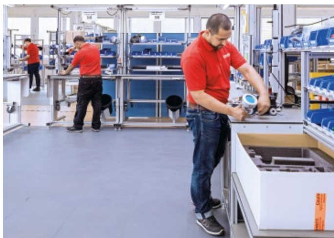
Abb. 3: Montage des Luftkeimsammlers MAS-100 NT zur mikrobiologischen Luftüberwachung in Reinräumen bei Femron.
