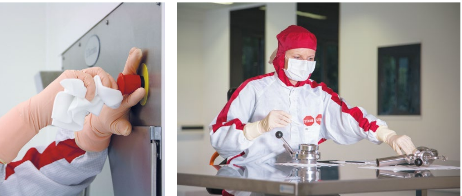
Abb. 2: Rechts: Die Entscheidung zum detaillierten Vorgehen muss für jedes Einzelteil neu getroffen werden. Links: Druckknopf abheben und arretieren, Unterseite wischen, Knopf lösen, Oberseite bearbeiten. (Quelle: Cleanroom Media / Rene Dreyer)
