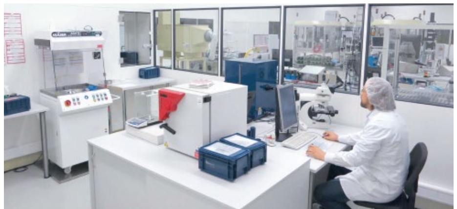
Abb. 2: Beim Betrieb eines Sauberkeitslabors ist entscheidend, dass es direkt in die Fertigungsumgebung implementiert wird – und zwar so, dass die Wege zwischen den Produktionsschritten und dem Labor kurz sind.
