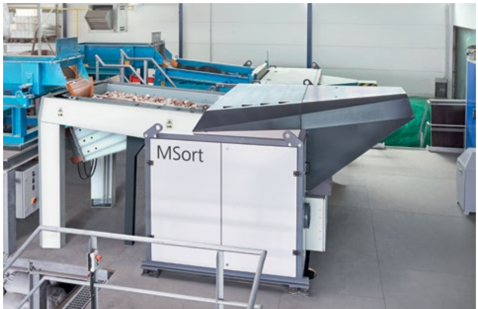
Abb. 3: Mit der MSort NIR Typ AS lassen sich Mineralien im Kornband von 15 bis 130 mm separieren. Sie ist speziell für raue Bedingungen ausgeführt und besitzt eine Durchsatzleistung von bis zu 120 t pro Stunde.
