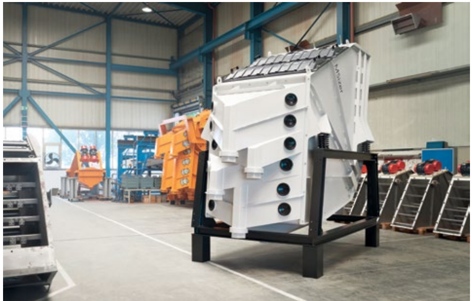
Abb. 2: Der MSizer extend basiert auf dem vor mehr als fünf Jahrzehnten von Fredrik Mogensen entwickelten Sizer-Prinzip. Seine zwei bis sechs Siebdecks erlauben durch den schnellen Siebwechselmechanismus eine erhebliche Reduktion der Umrüstzeiten.
