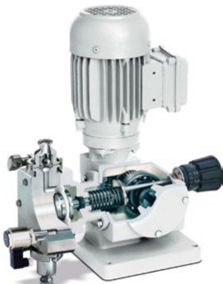
Abb. 3: Durch die tottraumoptimierte Konstruktion des Pumpenkopfes lassen sich Spül-, Entleer- oder Trocknungsvorgänge problemlos durchführen.
