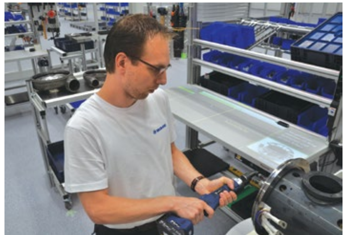
Abb. 2: Die Bauteilcodierung erzeugt eine Projektion der Arbeitsanweisungen und Montageinformationen, die direkt im Sichtbereich des Beschäftigten erscheinen.
