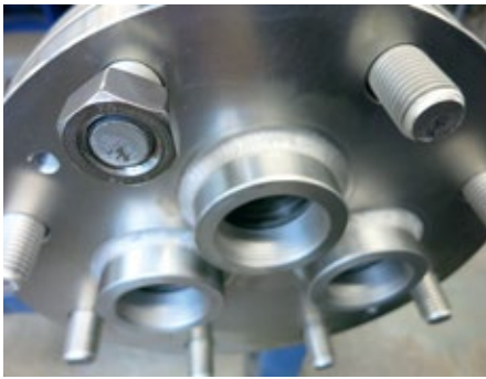
Abb. 1: Bisher hat DINO an der Flanschplatte eine Faserweichstoffdichtung mit Graphit als Füllstoff eingesetzt.
