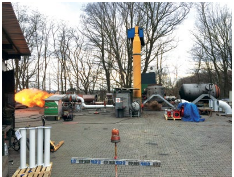
Abb. 3: Rückschlagklappen müssen jetzt eine strengere Prüfnorm (EN 16447) erfüllen. Die neue ProFlap III-Baureihe von Keller Lufttechnik meisterte die Tests erfolgreich.
