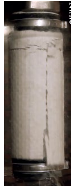
Abb.3: Grundlagen der Rückspülfiltration mit Filterkerzen
