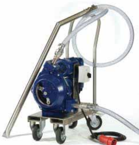
Abb. 1: Die P_classic 35 zum Entfernen von Fettschlamm aus einer Auffangwanne wurde saugseitig über einen medienbeständigen Schlauch mit einer speziell ausgelegten Sauglanze und abgeflachter Spachteldüse versehen.
