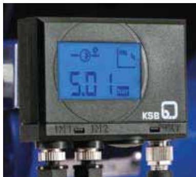
Abb. 1: Der PumpMeter wertet die ermittelten Betriebsdaten fortlaufend aus, erstellt ein Lastprofil und weist den Betreiber darauf hin, ob er durch die Verwendung einer Drehzahlregelung Energie einsparen kann.
