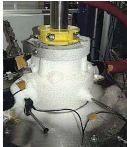
Abb. 2 : Gleitringdichtung auf dem Prüfstand bei -80 °C, Temperaturprofil in der Dichtung (Finite Elemente Analyse).
