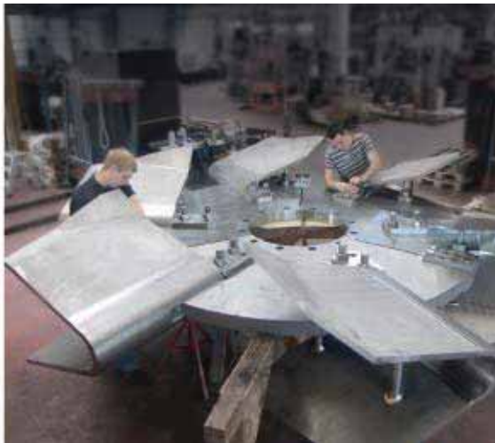
Abb. 1. „Economies of Scale“: 1000 m 3 Chemiereaktor zur Oxidation von Xylol, Konkavrührer zum Dispergieren großer Gasmengen.
