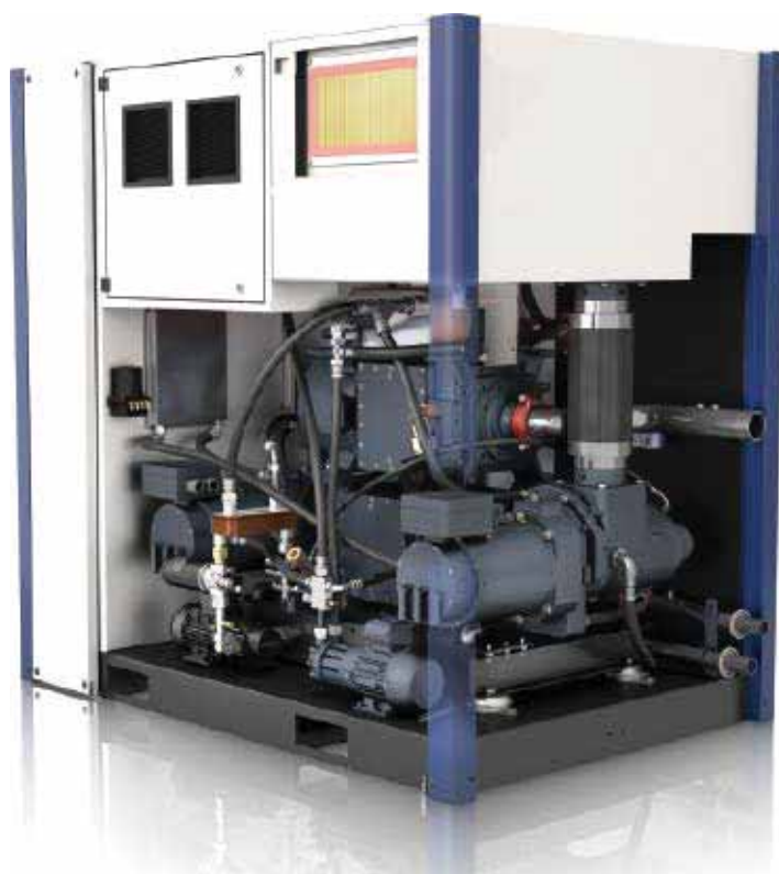
Abb. 1: Im Gegensatz zu herkömmlichen ölfreien Kompressoren, die über einen Einzelmotor und ein mechanisches Getriebe zum Antrieb der Nieder- und Hochdruckseite verfügen, nutzt Ultima zwei Permanentmagnetmotoren als Ersatz für Getriebe und Einzelmotor. © GardnerDenver
