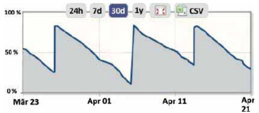
Abb. 4: Füllstand: Mustertank Das Absinken des Füllstandes in einem Gastank
