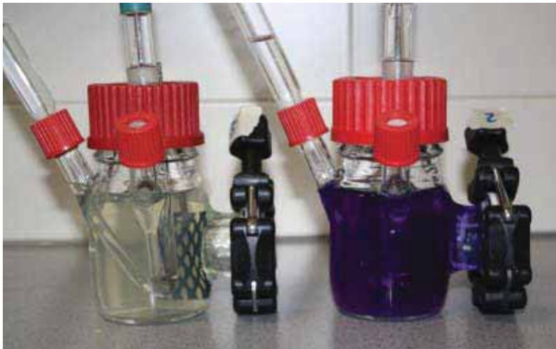
Abb. 2: Ungetrennte elektrochemische Glasreaktoren für die mikrobielle Elektrosynthese im Labormaßstab mit integrierter Anode, Kathode und Referenzelektrode.
