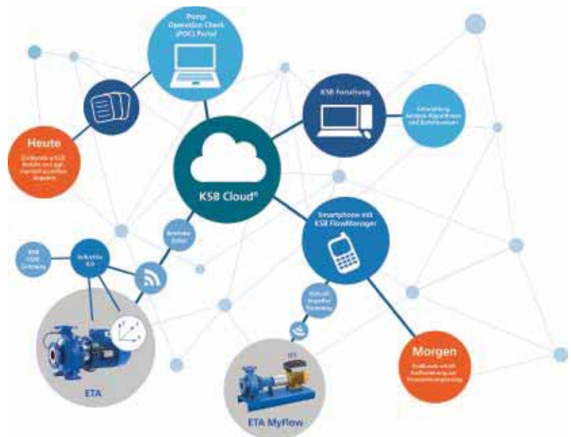
Abb. 2: Die Betriebsdaten werden über ein Portal in die Cloud gestellt. KSB verarbeitet die Daten und der Anwender erhält ein automatisch generiertes PDF mit eindeutigen Empfehlungen und eventuellen Verbesserungsvorschlägen für seine Pumpe.
