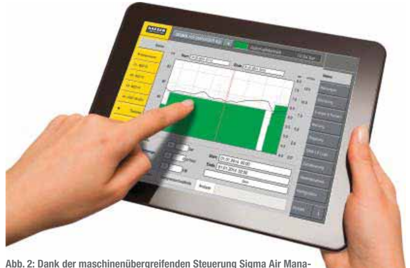
Abb. 2: Dank der maschinenübergreifenden Steuerung Sigma Air Manager 4.0. können Daten in Echtzeit übertragen und ausgewertet werden.
