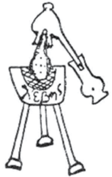
Abb. 1: links: ein wunderschön erhaltener Alembik aus Glas, Alexandria 5.-8. Jh.n.Chr.; rechts: Destillationsapparat von Demokrit, oder Alembik von Synesios, λεβηζ: lebes, Kessel [1]
