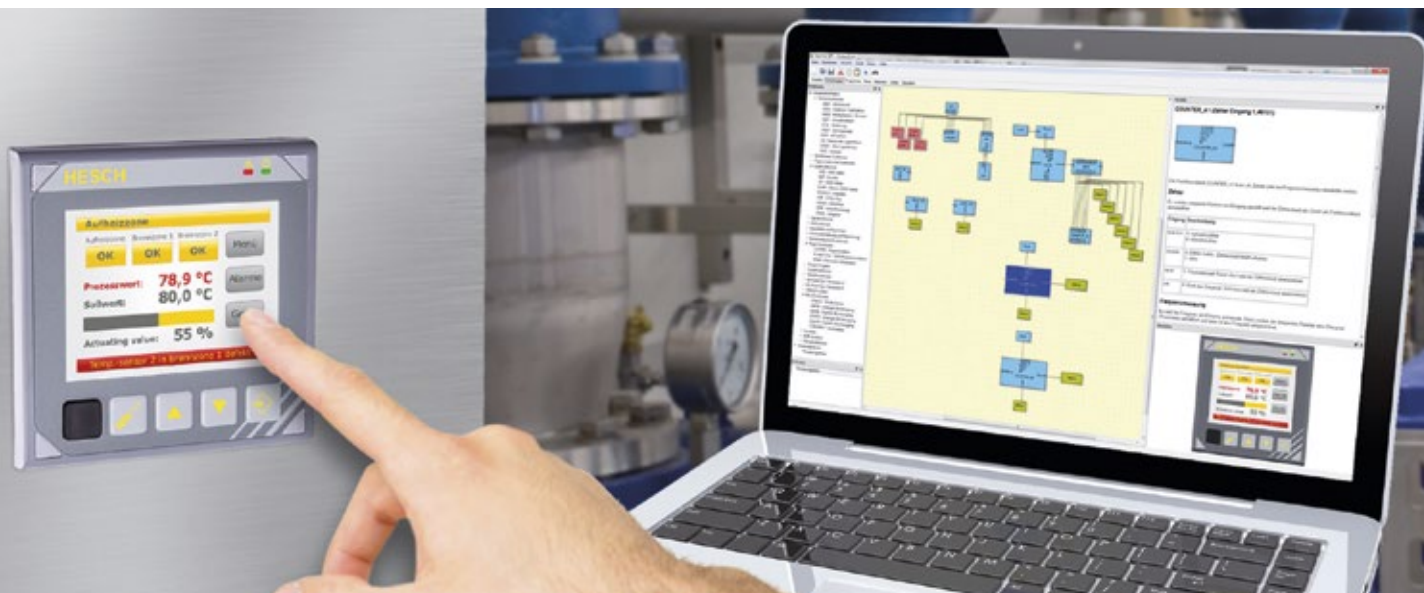
Abb. 1: Der Hesch MFC versetzt Verfahrenstechniker sofort in die Lage, Ablaufsteuerungen inklusive Regelungstechnik selbst zu erstellen, ohne programmieren zu müssen.
