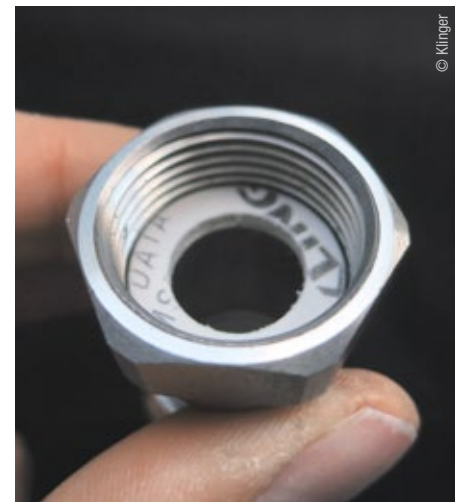
Abb. 5: Klinger top-chem 2003 ist ein Weichstoffdichtungsmaterial für den Temperaturbereich von -200\text{ °C} bis ca. 200\text{ °C} . Es ist in den Standarddicken 1,0 mm, 1,5 mm, 2,0 mm und 3,0 mm verfügbar.
