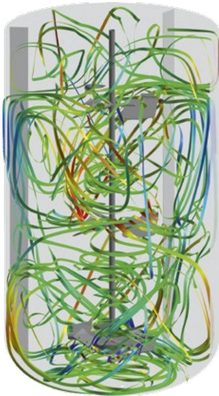
Abb. 1: Begasungsrührsystem Ekato Phasejet und Combijet.
