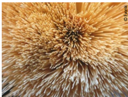
Abb. 2: Ein Bündel Hohlfasermembranen
