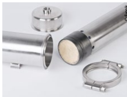
Abb. 3: Sepuran Green Module bestehen aus mehreren tausend Hohlfasern, die aus Hochleistungskunststoff hergestellt und in einem Edelstahlrohr gebündelt werden.
