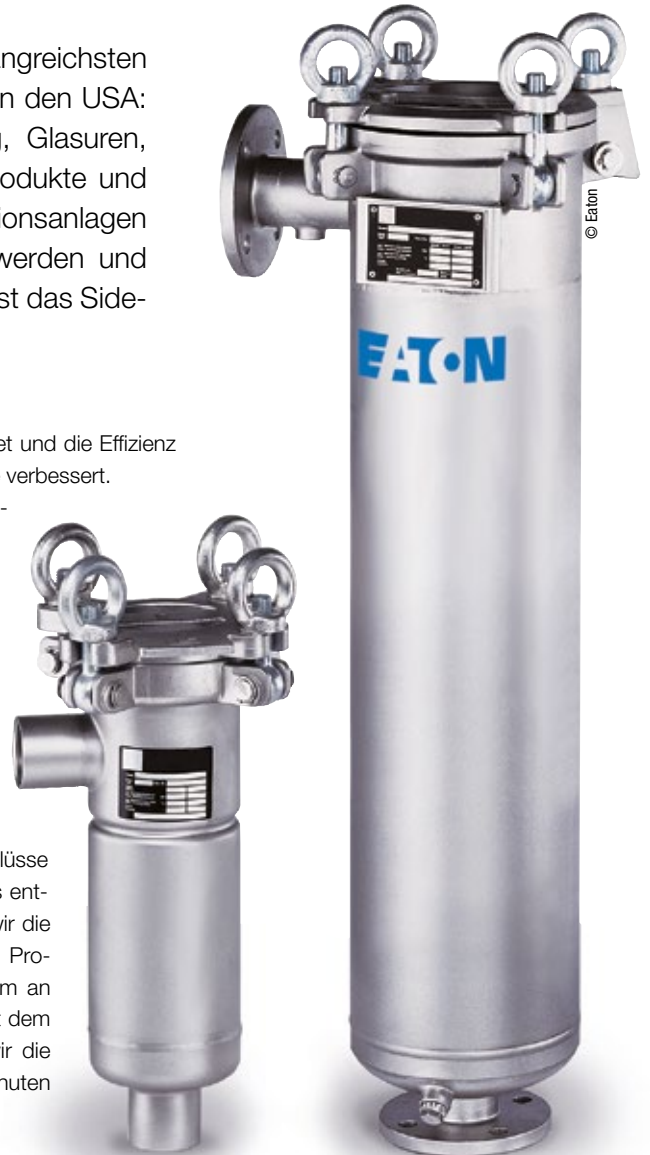
Abb.: Das einplätziges Sideline-Beutelfiltergehäuse ist ein Feingussfilter und eignet sich für die meisten schwierigen Industrieanwendungen. Der seitliche Einlass mit Verdrängerdeckel verhindert den Austritt des Unfiltrats und macht einen einfachen und saubereren Filterbeutelwechsel möglich.
