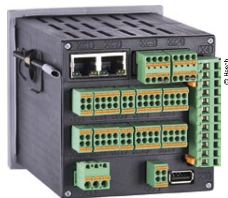
Abb. 4: Auf der Rückseite des Multifunktionscontrollers befinden sich Steckplätze für zwei I/O-Karten. Um Messwertverfälschungen durch eventuelle Potentialdifferenzen zu vermeiden, sind die I/Os auf galvanisch getrennten „Potentialinseln“ mit einer hohen Trennspannung angelegt
