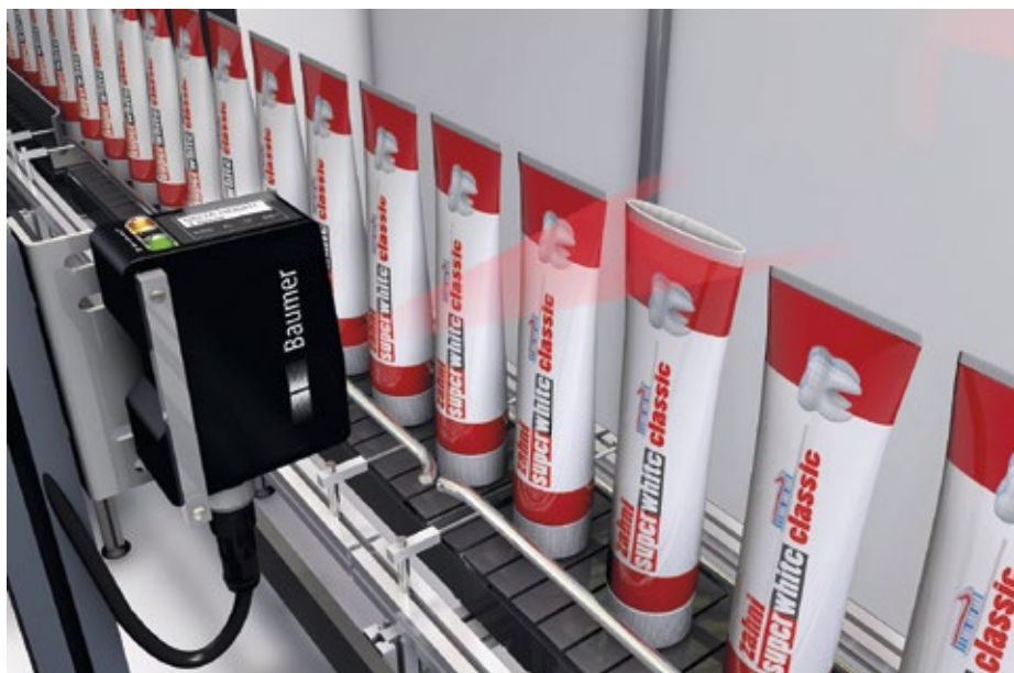
Abb. 2: Direktes Aussortieren schlecht verschweisster Zahnpaste Tuben durch Höhenmessung der Schweissnaht
