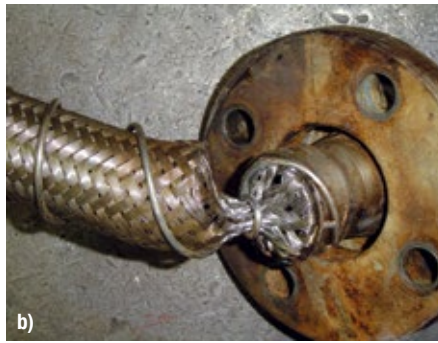
Abb. 1 a-c: Schlauchschäden durch nicht bestimmungsgemäßen Betrieb:
