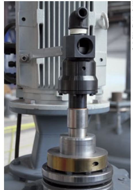
Abb. 4: Drehdurchführung für das Ein- und Ausleiten des Wärmeträgeröls an der emaillierten Rührwelle
