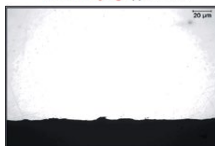
bei G-35 Alloy: Keine Anzeichen von Entlegierung erkennbar.
