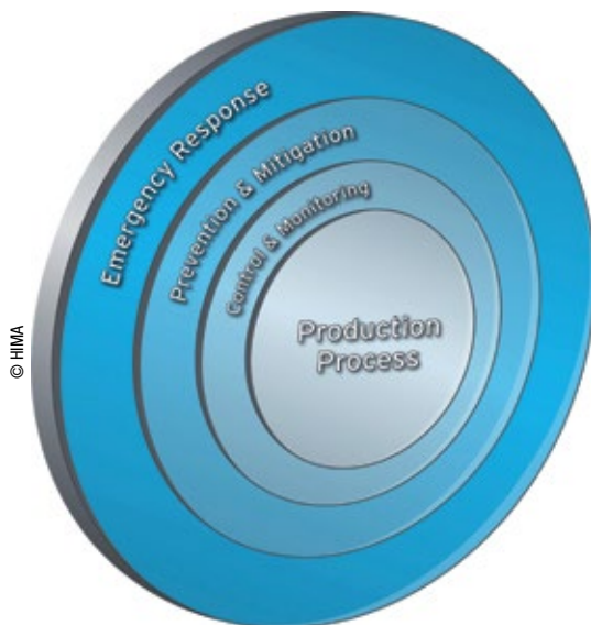
Abb. 1: Sowohl die Safety- als auch die Cyber-Security-Norm fordern getrennte Schutzebenen.
