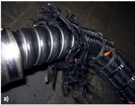
Abb. 1 a-c: Schlauchschäden durch nicht bestimmungsgemäßen Betrieb:
