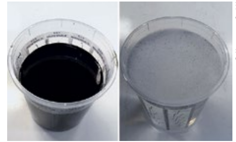
Abb. 6: Erfolgskontrolle der Reinigung. Es wird jeweils reines Aceton in den Ladeluftkühler gefüllt, und nach fünf Minuten wieder entnommen. Links: Verunreinigtes Lösemittel zeigt einen innen verschmutzten Wärmetauscher an. Rechts: Klares Lösemittel zeigt einen innen sauberen Wärmetauscher an.
