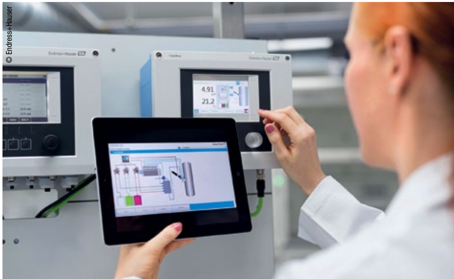
Abb. 2: Auch der Fernzugriff für die Konfiguration, Wartung oder Diagnose z.B. mit Standardtablets läuft über Ethernet.
