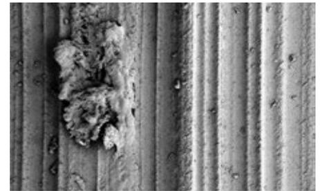
Abb. 4: Abrasivverschleiß eines Kunststoffes
