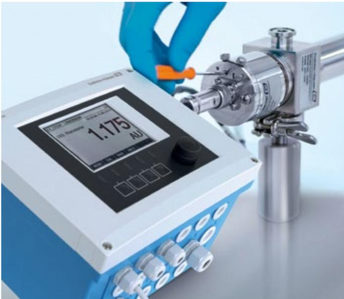
Abb. 2: Die Kalibrierung mit zertifizierten optischen Filtern ist einfach und ermöglicht reproduzierbare Ergebnisse über einen langen Zeitraum.
