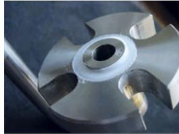
Abb. 2: Ventilblöcke mit PTFE-Dichtungen sind beim Einsatz unter hohen Temperaturen deutlich im Nachteil: Der Kunststoff wird bei großer Hitze sehr weich, weshalb der Druck des Prozessmediums ihn in verfügbare Hohlräume presst.
