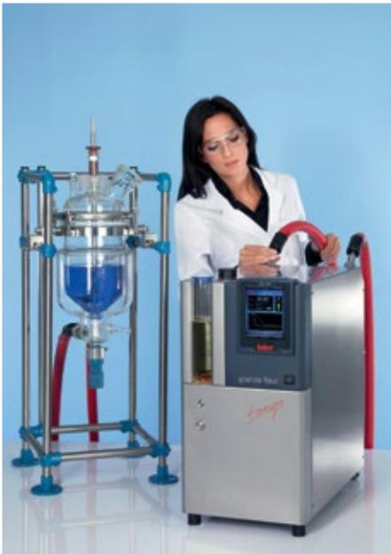
Abb. 2: Beim Anschluss sollte darauf geachtet werden, dass geeignete Schläuche verwendet werden und dass diese nicht gequetscht werden.
