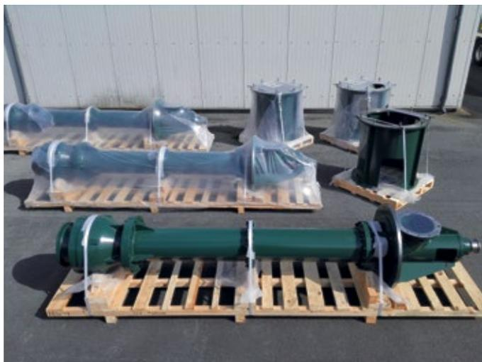
**Abb. 2: Capraris High Flow-Pumpen wurden 14 Wochen nach der Bestellung geliefert. An der Pumpe vorn im Bild befindet sich die Ansaugöffnung links, der Pumpenkopf mit Druckanschluss und Motorkupplung rechts.**
