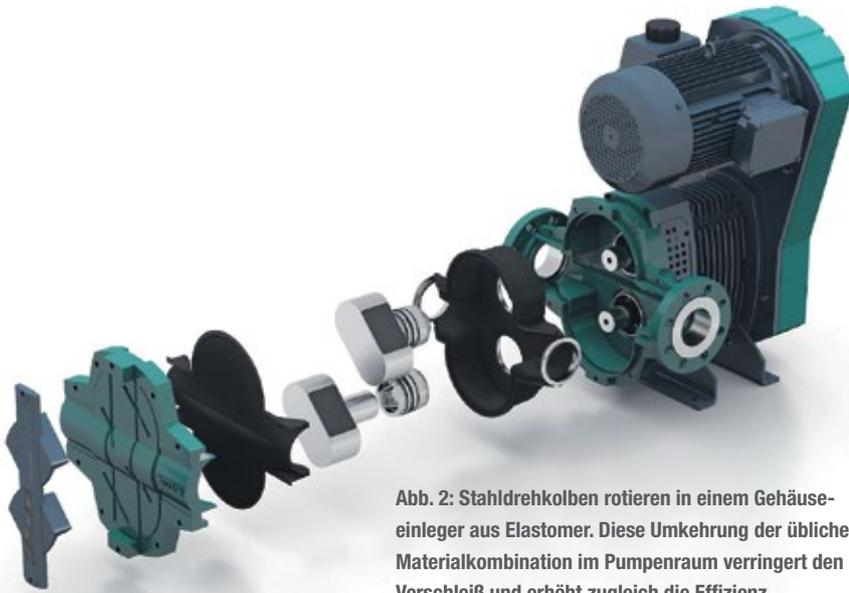
Abb. 2: Stahldrehkolben rotieren in einem Gehäuseeinleger aus Elastomer. Diese Umkehrung der üblichen Materialkombination im Pumpenraum verringert den Verschleiß und erhöht zugleich die Effizienz.
