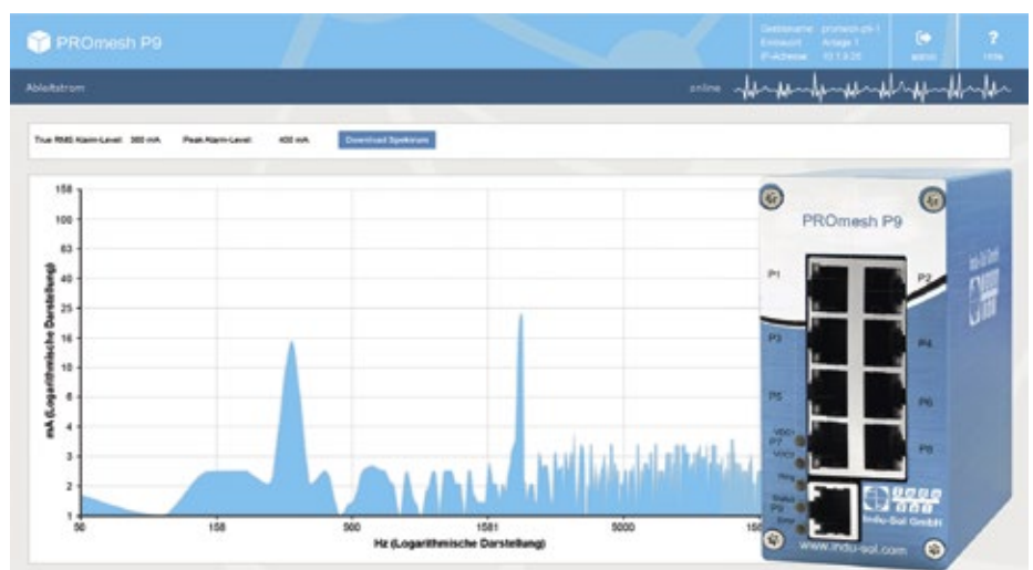
Abb. 3: Als bislang einziger Switch überwacht der PROmesh P9 die EMV-Belastung des Netzwerks. In Kombination mit den netzwerkspezifischen Diagnosedaten ergibt sich so ein präzises Bild der Situation, mögliche Störeinflüsse können so leichter lokalisiert werden.
