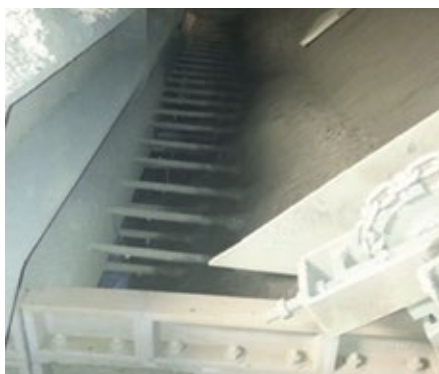
Abb. 5. Die Zuführung der Sinteranlage erfolgt mit zwei Reihen von horizontalen Permeabilitätsstäben.
