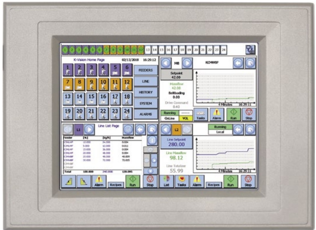
Abb. 1: Im Quad-Modus der K-Vision-Steuerung können vier Bilder parallel angezeigt werden.
