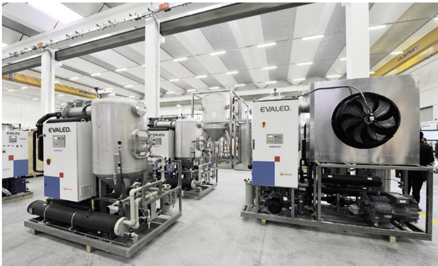
Abb.: Die Ehaled-Systeme von Veolia minimieren durch Verdampfung das Abwasservolumen und reduzieren Entsorgungskosten maßgeblich.
