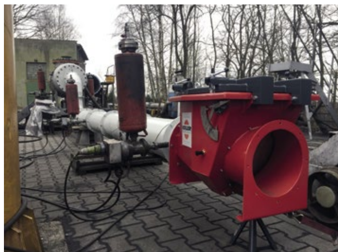
Abb. 2: Die verbesserte Rückschlagklappe ProFlapIII mit noch dichter schließender Klappe sowie einer automatischen Verriegelung für den Ernstfall absolvierte die Prüfungen nach der neuen, strengeren Norm EN 16447.
