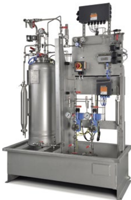
Abb. 1: Lewa hat ihr bisheriges Mikrodosierpumpen-Portfolio um das Modell MAH 4 erweitert: Das Aggregat, das eigens für einen Förderbereich von 200–250 ml konzipiert wurde, kann Gase bei einem Druck bis 16 bar odorieren und ist somit eine besonders kosteneffiziente Lösung für Gasnetze bis PN 16.
