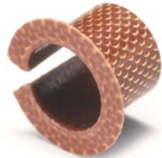
Abb. 3: Bei den Hiplast-Gleitlagern handelt es sich um dünnwandige Multilayer-Lösungen, bestehend aus einem Mikrogeflecht aus Streckmetall und einer PTFE-Füllmasse, die zugleich die Gleitschicht bildet.
