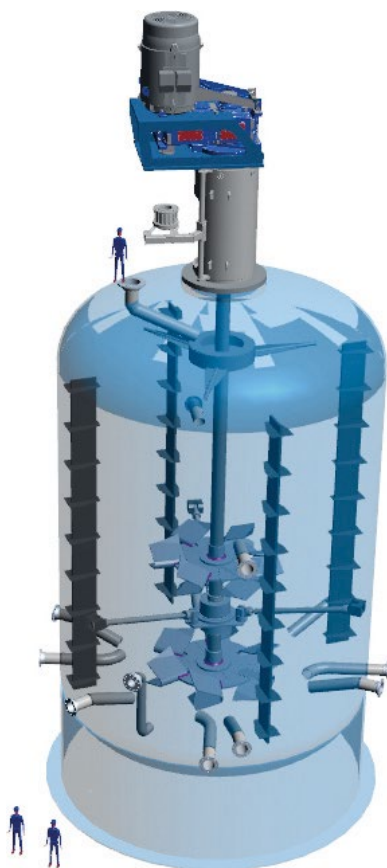
◀ Abb. 1: Oxidationsreaktor mit 2-stufigem Begasungsrührer Ekato Phasejet
