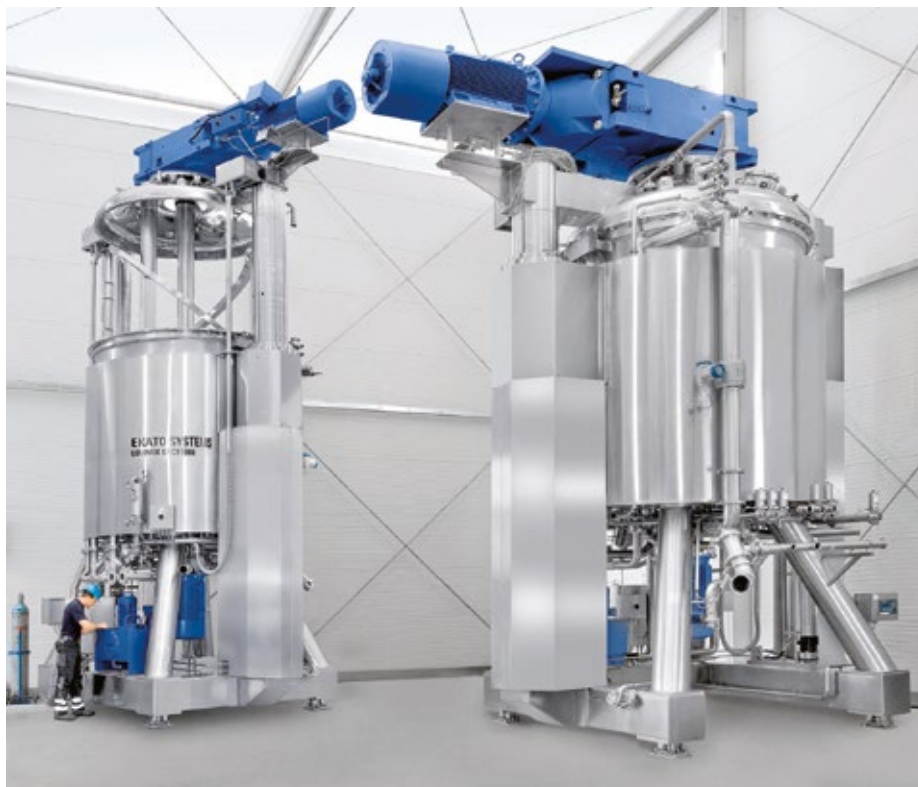
◀ Abb. 1: Oxidationsreaktor mit 2-stufigem Begasungsrührer Ekato Phasejet
