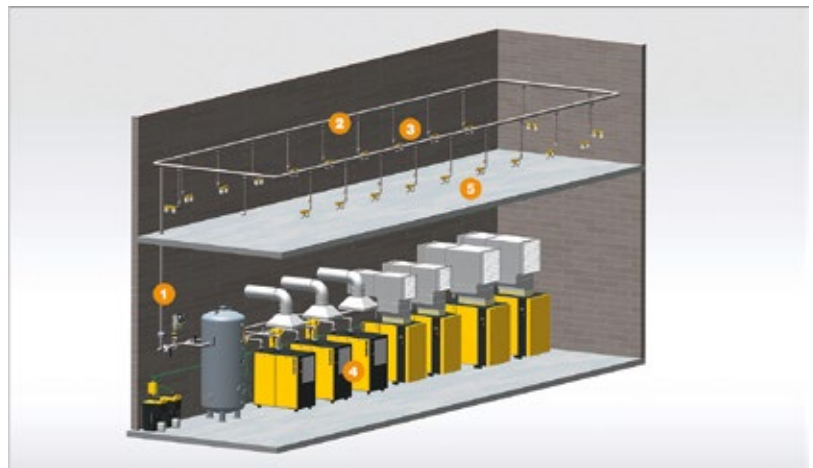
Abb. 2: Hauptbestandteile eines Druckluft-Verteilungssystems: Hauptleitung (1), Verteilerleitung (2), Anschlussleitung (3), Trockner (4), Wartungseinheit/Schlauch (5).
