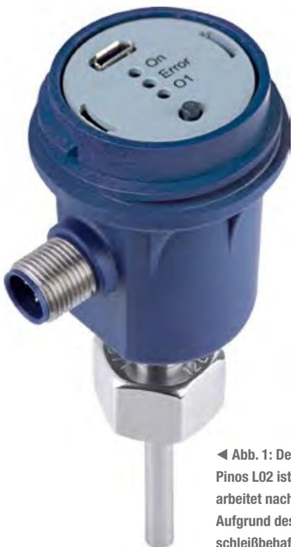
◀ **Abb. 1:** Der neue Strömungssensor Jumo Pinos L02 ist für Flüssigkeiten konzipiert und arbeitet nach dem kalorimetrischen Messprinzip. Aufgrund des Messverfahrens sind keine verschleißbehafteten beweglichen Teile enthalten.
