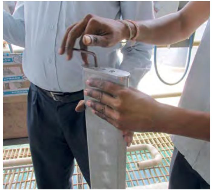
Abb. 3a+b: Ausrüstung einer austauschbaren Filterzelle mit einem Filterbeutel.
