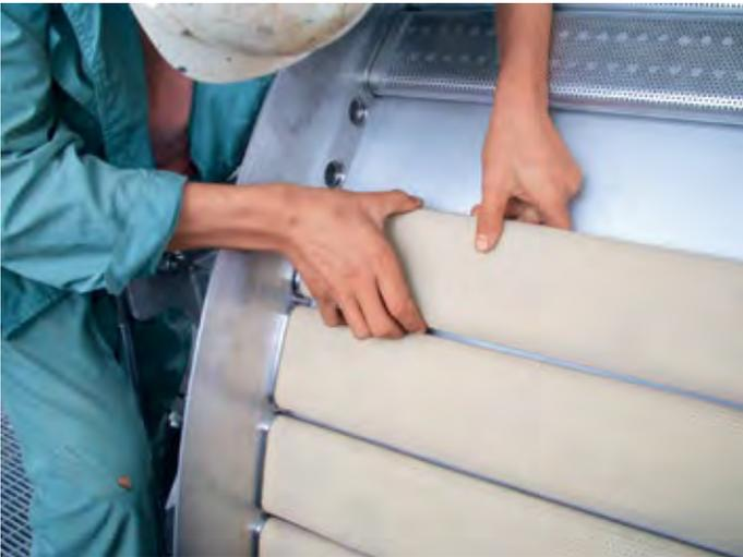
Abb. 4: Filtertuchwechsel durch Installation eines Satzes vorgerüsteter Filterzellen auf der Filtertrommel; Fixierung jeder Zelle mit nur einer Klemmschraube..
