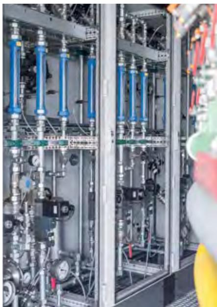
Abb. 2: Komplettes Gasrack für einen Härteofen.
