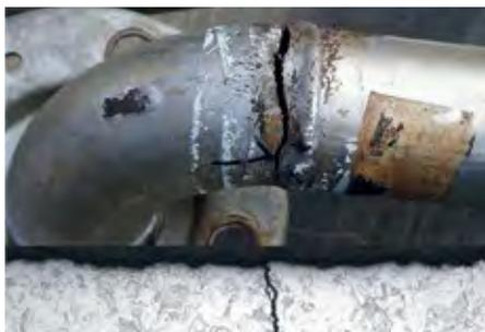
Abb. 2: Chloridbedingte Spannungsrisskorrosion an einem Rohr aus nichtrostendem Stahl.
