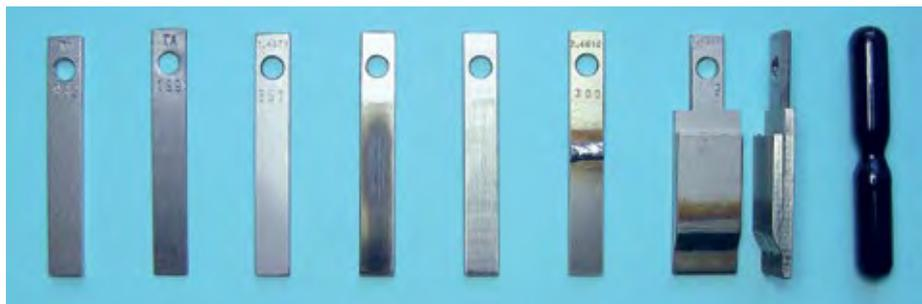
Abb. 3: Art der Korrosionsproben. Von links nach rechts: normal, geschliffen, geschweißt, Spaltproben und Email. Die meisten Werkstoffe vom unlegierten Stahl bis zum Tantal sind vorrätig.
