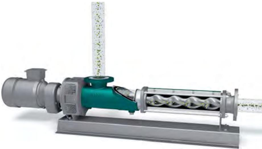
Abb. 1: Die Exzenterschneckenpumpen basieren auf einem gewendelten Rotor, der sich in einem feststehenden Stator dreht. Dabei bilden sich geschlossene Förderkammern, in denen das Medium sanft transportiert wird.
