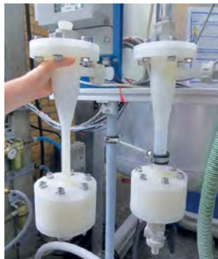
Abb. 4: Optimierter Zyklon „XE“ (links) mit einem dünneren, schlankeren Design und höherer Abtrennleistung.
