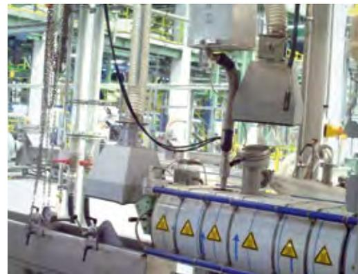
Abb. 4: Absaugung Extruder mit Elektrofilter und Luftvorwärmung – Flexible Absaughauben (Teleskophauben)
