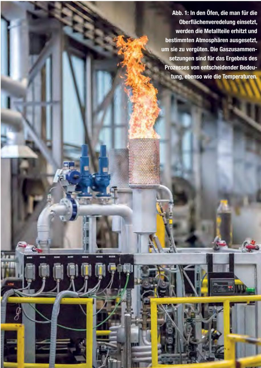
Abb. 1: In den Öfen, die man für die Oberflächenveredelung einsetzt, werden die Metallteile erhitzt und bestimmten Atmosphären ausgesetzt, um sie zu vergüten. Die Gaszusammensetzungen sind für das Ergebnis des Prozesses von entscheidender Bedeutung, ebenso wie die Temperaturen.
