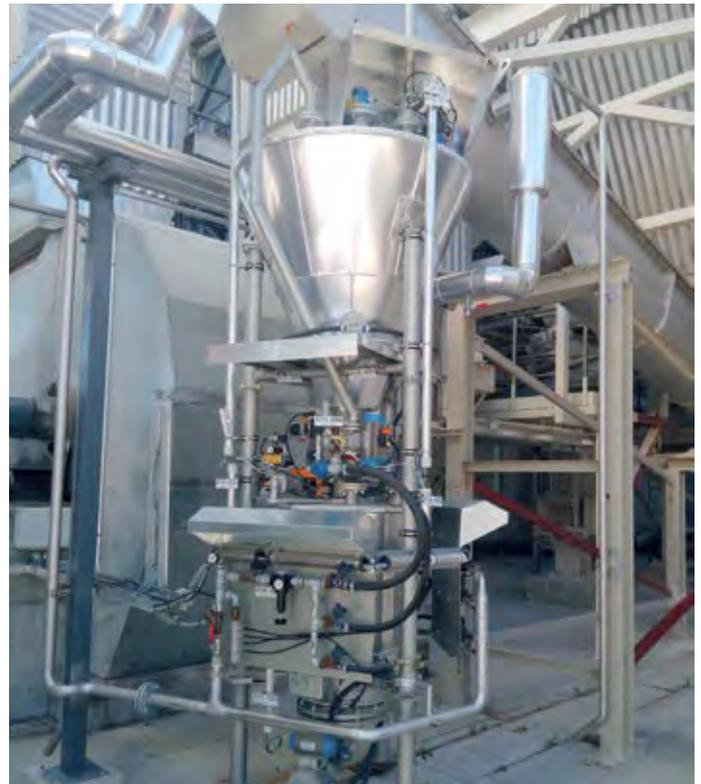
Abb. 2: Zur staubfreien Überführung des Produktstromes in einen Silo-LKW, wird eine solids TLC3 Verladeeinrichtung mit heb- und senkbarem Balg, sowie direkter Entstaubung über einen integrierten Systemfilter montiert.
