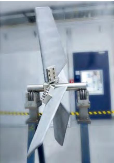
Abb. 2: Rührorgan mit massiven keramischen Blättern und einem Durchmesser von 2,1 m.
