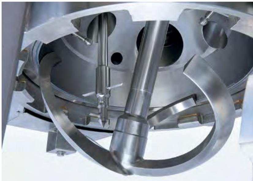
Abb. 1: Dreiarmrührer mit verbesserter Wärmeübertragung und Hochleistungs-Zerhacker
