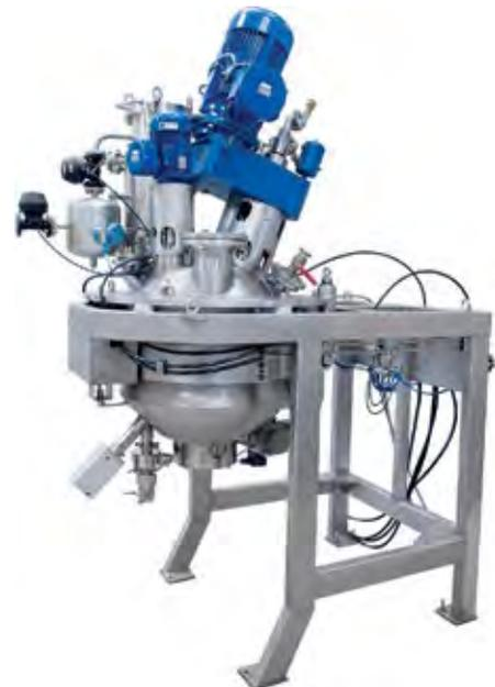
Abb. 3: Pilotanlage mit Rosenmund-Kugeltrockner
