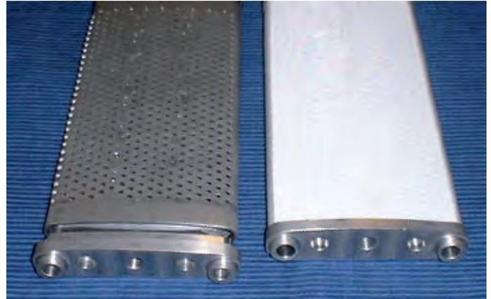
Abb. 2: Austauschbare Filterzellen.
