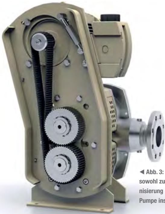
◀ **Abb. 3: Der Riementrieb dieser Pumpe dient sowohl zur Kraftübertragung als auch zur Synchronisierung der Kolben. Die Doppelfunktion macht die Pumpe insgesamt sehr leicht und kompakt.**
