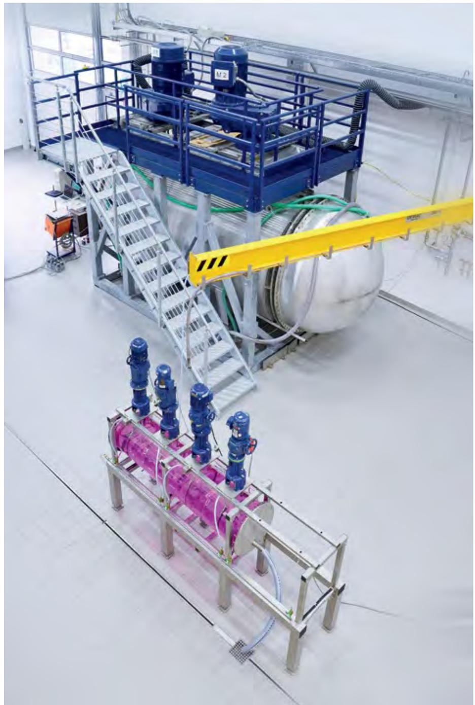
Abb. 6: Versuchsautoklaven 200 Liter und 15 m<sup>3</sup> im Ekato Technologiezentrum.
