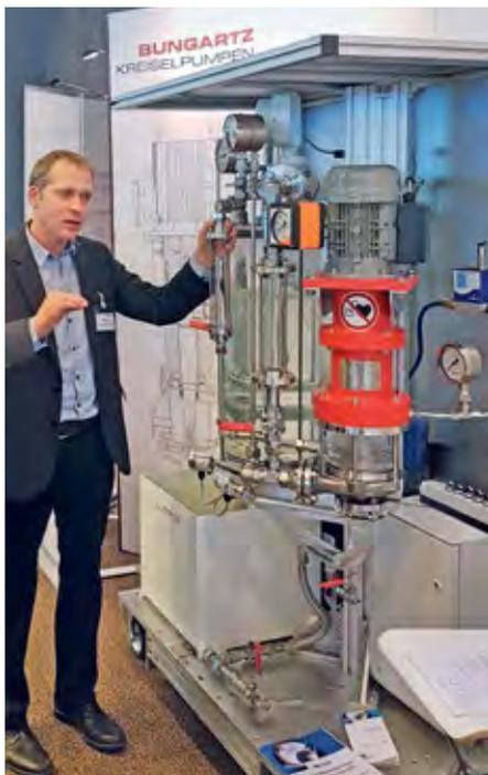
Abb. 2: Sadko Meusel erläutert das Pumpenprinzip der trockenlaufsicheren magnetgekuppelten Vertikalpumpe MPCV-AN anhand eines Funktionsmodells
