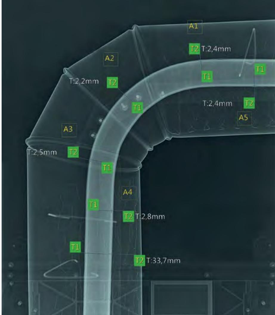
Abb. 2: Etwa 1.500 analoge und digitale Röntgenbilder erstellt Bureau Veritas für Schattenaufnahmen der Wanddicken und Außen-/Innenkorrosion. Darunter befinden sich auch genauere Detailaufnahmen für die Fehlererkennung bei Schweißnähten.
