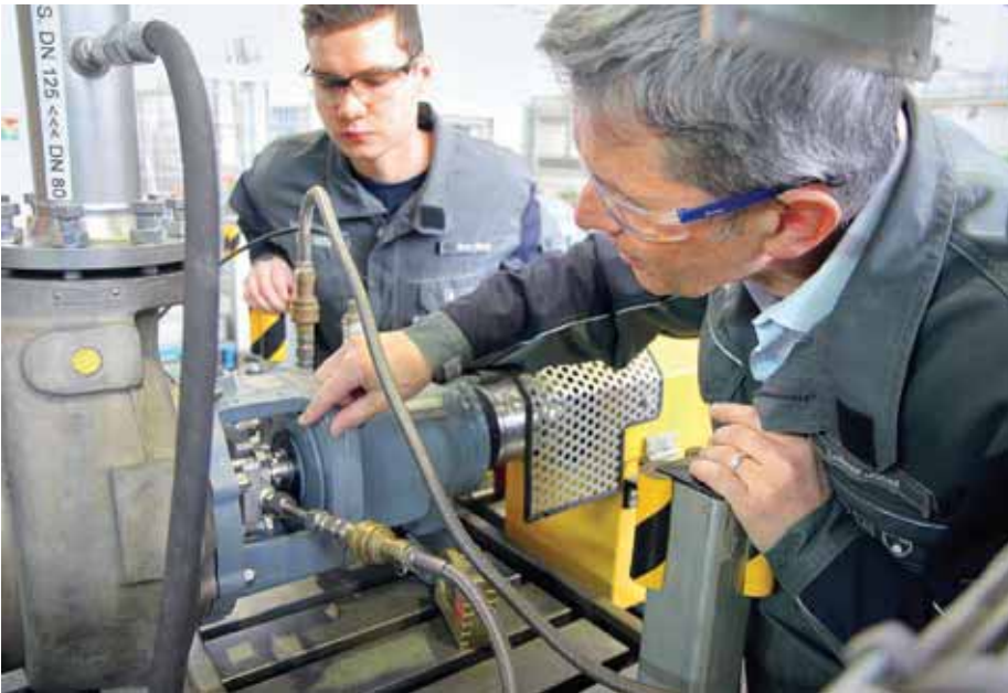
Abb. 1: Am vollautomatischen Pumpenprüfstand der InfraServ Gendorf Technik können reparierte Pumpen einer Funktionsprüfung unterzogen und genaueste Angaben z.B. zu Dichtheit, Leistung und Schwingungen gemacht werden. Kunden profitieren von genauesten Messwertprotokollen zur Qualitätskontrolle und einer authentischen Dokumentation über in Auftrag gegebene Instandsetzungsmaßnahmen.
