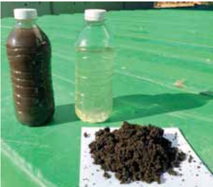
Abb. 1: Links: Schlamm vor der Entwässerung; Rechts: Flüssigphase nach der Zentrifuge sowie ausgetragener Feststoff
