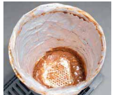
Abb. 3a+b: Beispiel für Restmenge im Fass. a) Vaseline, b) mit Aseptic Bag: Karamell.
