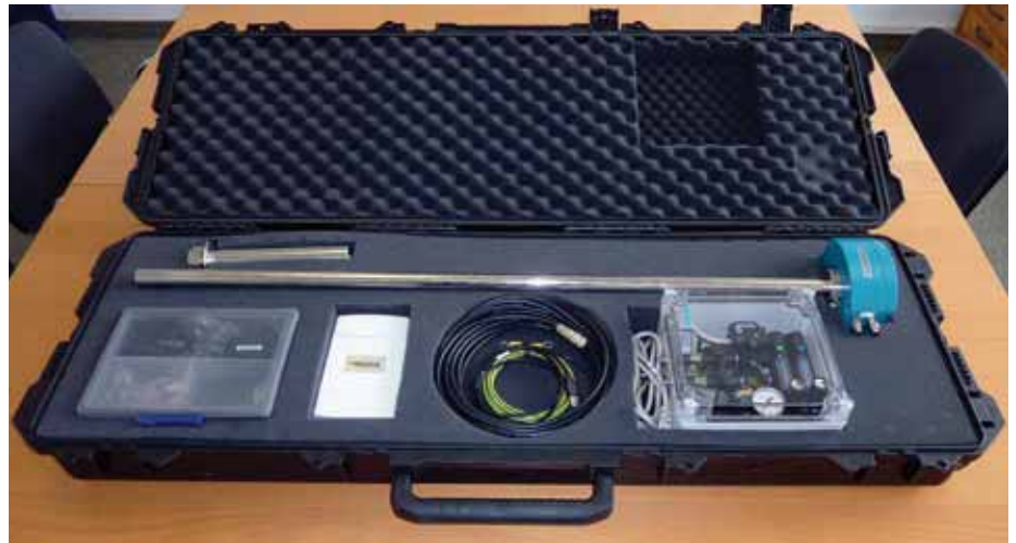
Abb. 1: Die IPP 75-S wird bei einer Partikelgröße von 50 µm–6 mm und einer Partikelgeschwindigkeit von 0,01 m/s–50 m/s verwendet. Für die Messung wird die Sonde in das entsprechende Gefäß installiert, damit sie dort direkt im Partikelstrom messen kann.
