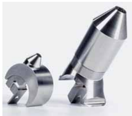
Abb. 2: Die Dispergierer D24 und D12 stellen mittlerweile die zweite Generation dieses Sondaufsatzes dar. Dank einer veränderten Strömungsgeometrie wird die Optik besser freigehalten, wodurch die Inline-Partikelmesssonden bis zu mehreren Wochen innerhalb der Prozesse verbleiben können, ehe sie gereinigt werden müssen.
