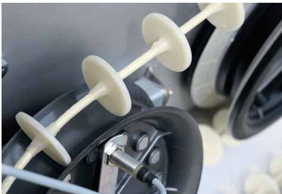
Abb. 2: Friktrionsrad als Reibrad übersetzt den Antrieb des 0,75 kW-Motors
