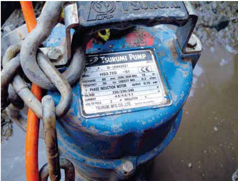
Abb. 2: Erster Blick aufs Typenschild: Sind alle Angaben vorhanden und plausibel?
