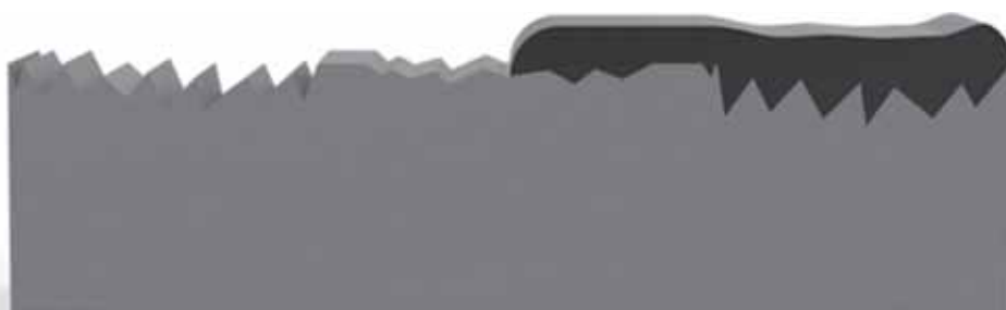
Abb. 3: Raue Oberfläche = Verwirbelung. Glatte Oberfläche = besserer Wirkungsgrad.
