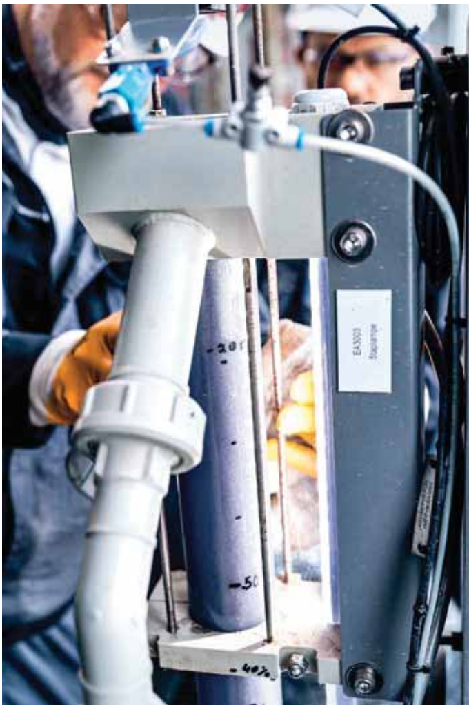
Abb. 1: Das Hauptelement des iFlocs ist eine Messzelle, in die in regelmäßigen Abständen die geflockte Suspension gepumpt wird. Oberhalb dieser ist der Laser angebracht, der senkrecht in das Medium leuchtet. Da er dabei nicht mit dem Fluid in Berührung kommt, besteht in keinem Fall das Risiko, dass er durch heiße, ätzende oder korrosive Stoffe im Abwasser beschädigt wird.
