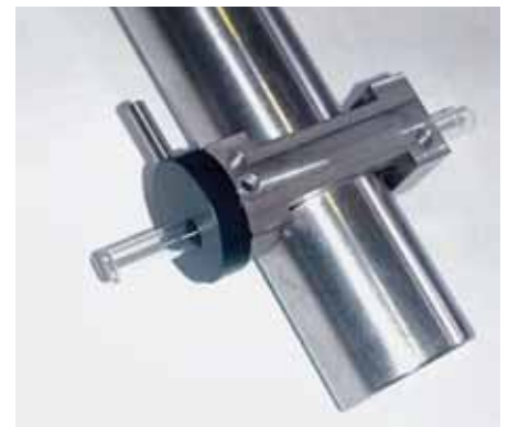
Abb. 3: Bei der Flüssigmesszelle FZ1 handelt es sich um ein weiteres Prozess-Interface, mit dem die Partikelgrößen-Verteilung in einem Fluid bestimmt werden kann. Dabei wird ein Glasrohr im Messvolumen der Sonde platziert und die Flüssigkeit mit Partikeln dank eines Bypassstroms in den Messkreislauf gepumpt.
