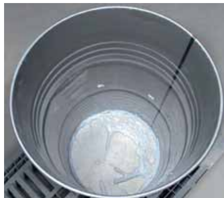
Abb. 3a+b: Beispiel für Restmenge im Fass. a) Vaseline, b) mit Aseptic Bag: Karamell.
