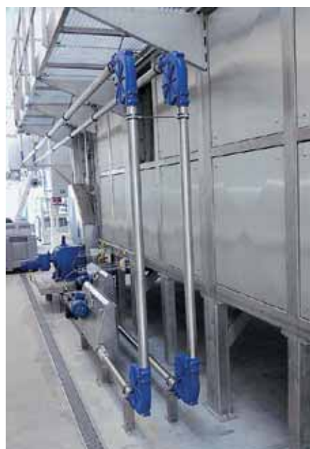
Abb. 1: Wessjohann Seilförderanlage, eingebunden in Fertigungslauf in der Lebensmittelindustrie
