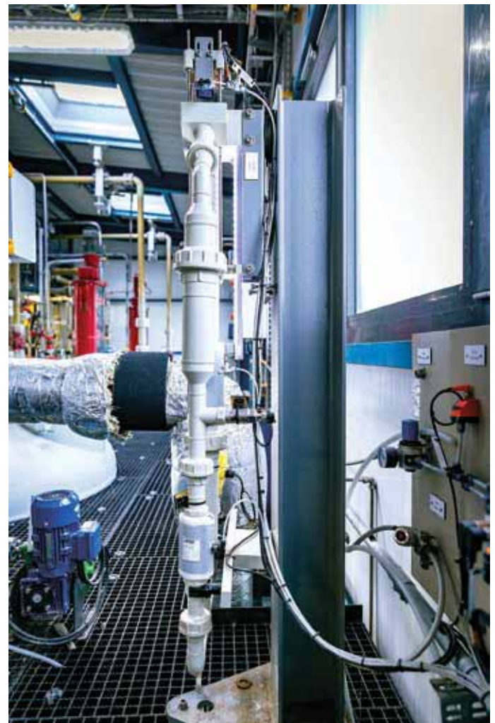
Abb. 2: Mit dem laserbasierten Messgerät iFloc können die Sinkgeschwindigkeit von Flocken, die Dichte, die Leitfähigkeit und die Temperatur sowie das Schlammvolumen nach Imhoff bestimmt werden. Auf Grundlage dieser fünf Parameter lassen sich eindeutige Aussagen über die Flockung treffen, sodass die Zugabe des Flockungsmittels bedarfsabhängig reguliert werden kann.
