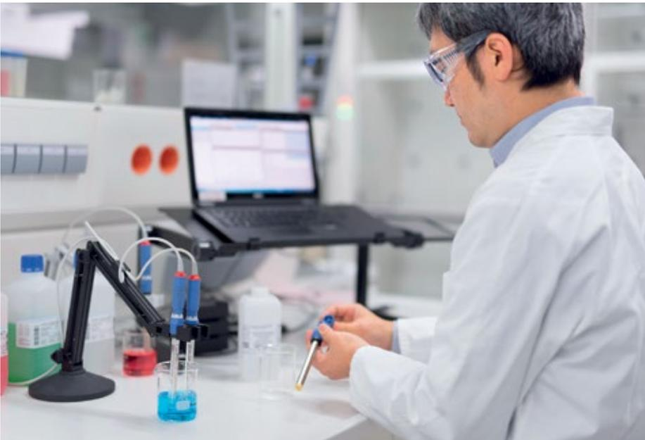
Abb. 2: Messen, kalibrieren und dokumentieren mit Memobase Plus CYZ71D
