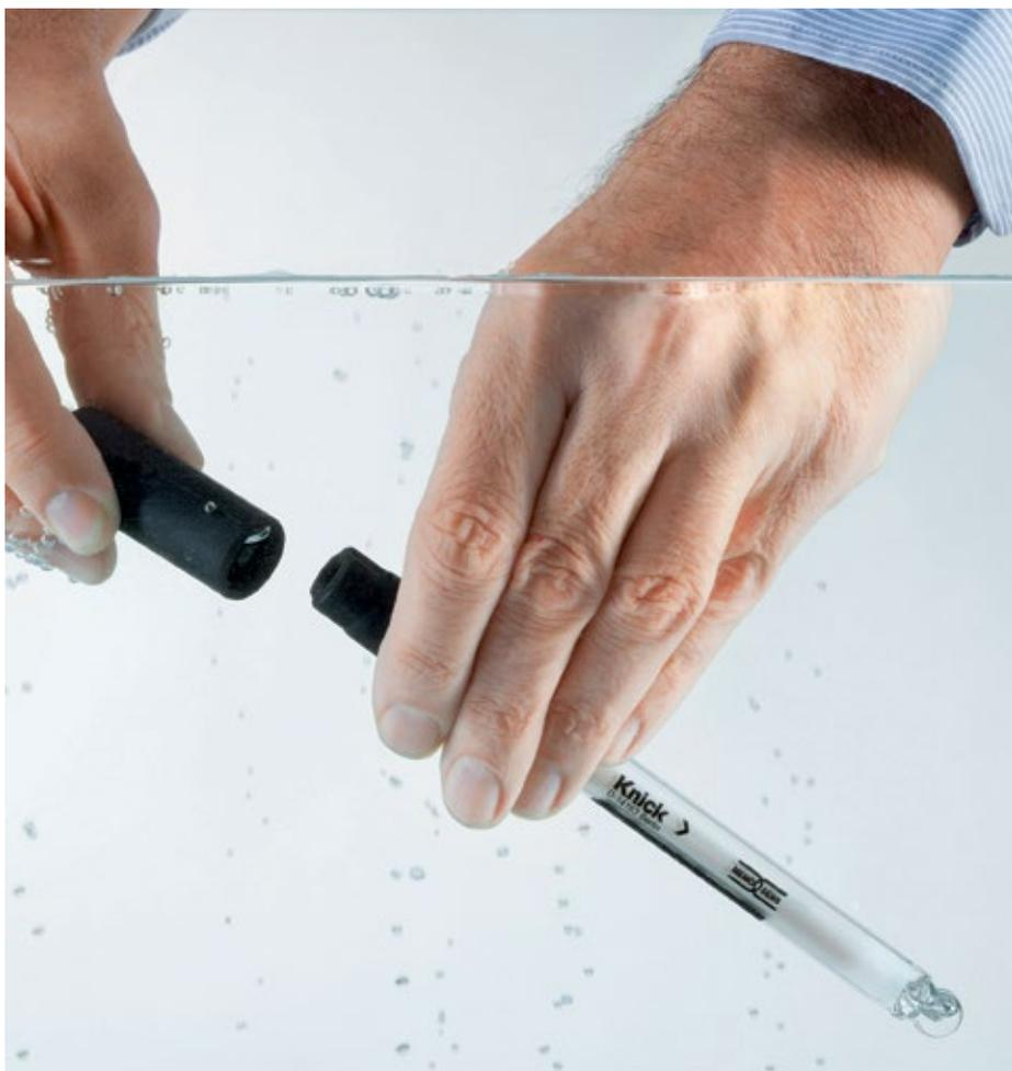
**Abb. 1:** Bei der digitalen Memosens-Sensortechnologie werden Sensordaten und Speisespannung kontaktlos übertragen. Da Feuchtigkeit oder Nässe die induktive Übertragung in den Sensorkupplungen nicht beeinflussen können, lassen sich Memosens-Sensoren sogar unter Wasser anstecken.
