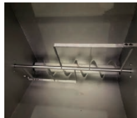
▲ Abb. 1: Einblick in den Aufnahmetrichter der Leiblein Dosierstation mit Brückenbrecher und Austragsschnecke
