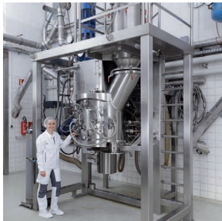
Abb. 2: TBF-Tiefbettfilter mit automatischem Vliestransport und Schmutzabstreifer
