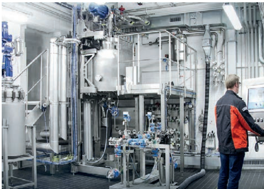
Abb. 2: Ekatos Hydriertechnikum mit 60 Liter, 100 bar Reaktor und Filtration
