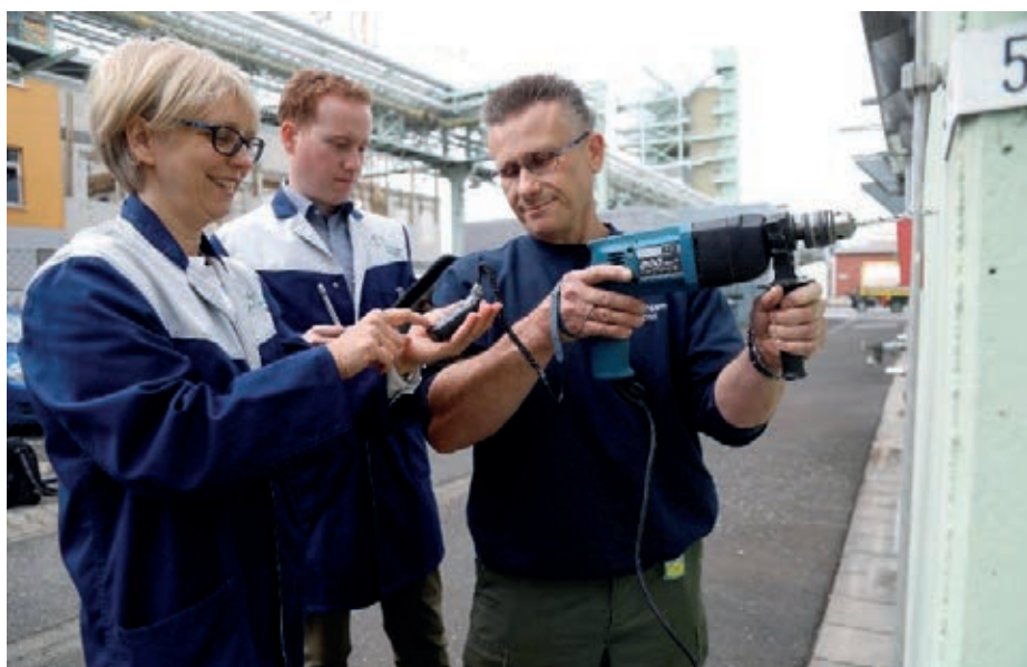
Abb.: Heike Bauerfeld und Pascal Friedrich (Mitte) messen bei Infracerv-Mitarbeiter Markus Kircher die Hand- und Armvibration beim Einsatz einer Bohrmaschine.
