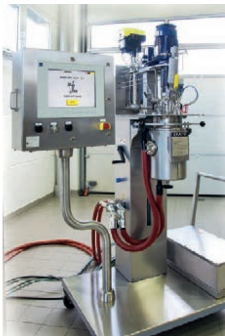
Abb. 1: Mobile 3 Liter, 100 bar Pilotanlage
