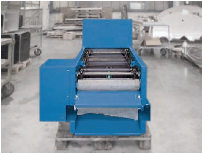
Abb. 2: TBF-Tiefbettfilter mit automatischem Vliestransport und Schmutzabstreifer
