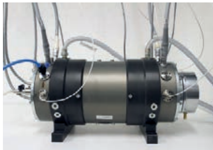
Abb.2: Magnetisch gelagerte und angetriebene Zentrifuge (MVM, CEPA, EAAT)
