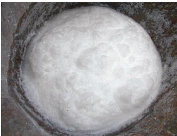
Abb. 1: Die Förderung des bei der Kautschukproduktion zwingend benötigten Trennmittels mit einer Kreiselpumpe führte zu ungewollter, intensiver Schaumbildung.
