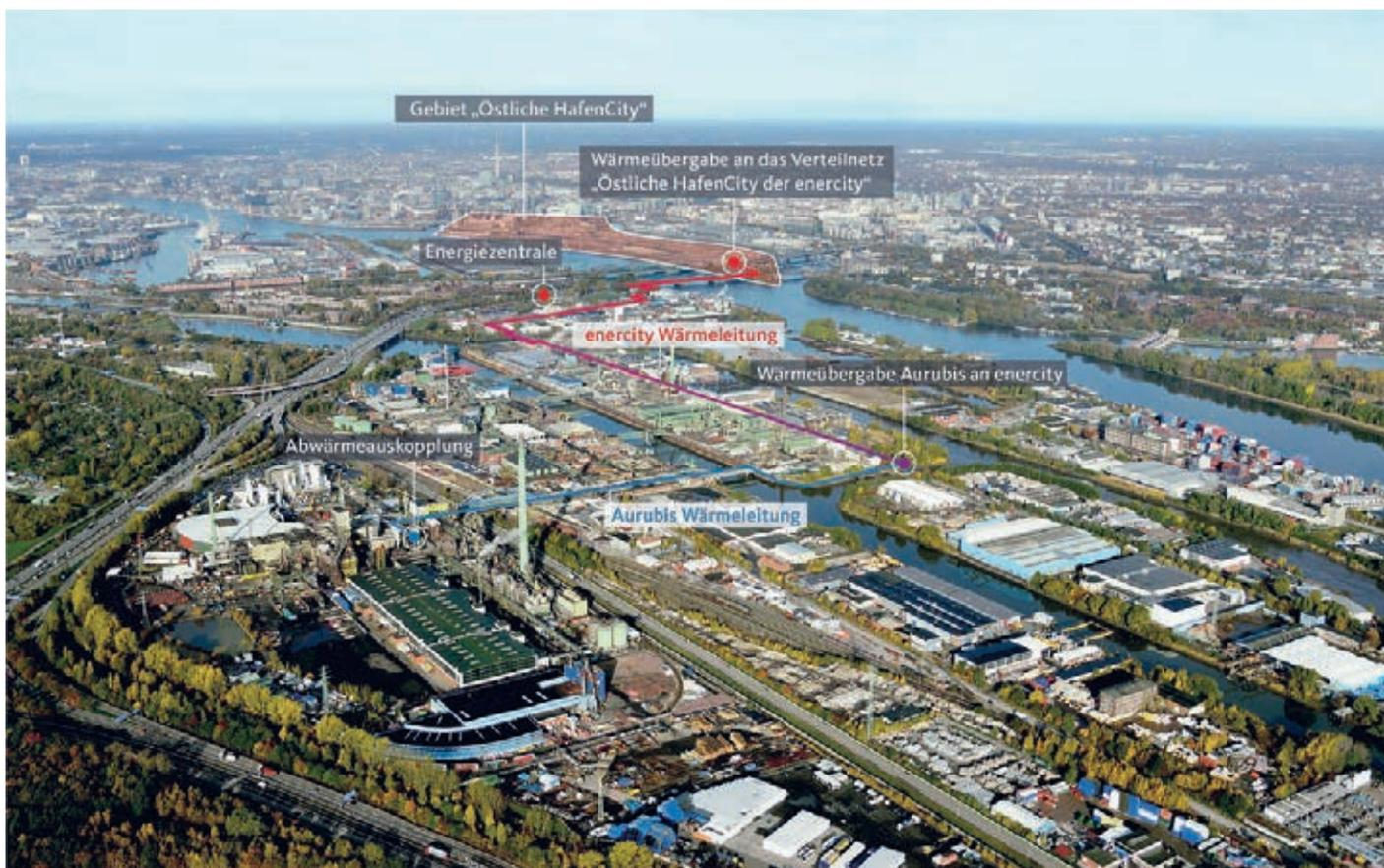
Abb. 3: Fernwärme wird der „östlichen Hafencity“ zur Verfügung gestellt und schafft die Einsparung von 4.500 t CO<sub>2</sub> pro Jahr.
