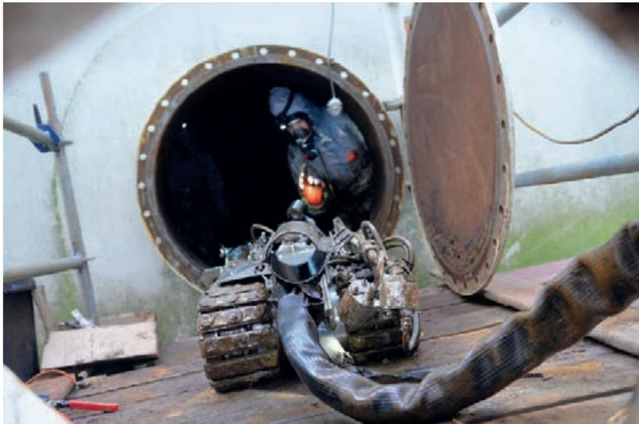
Abb. 1: Der 500 kg schwere Roboter ist so klein, dass er durch ein 60 cm durchmessendes Mannloch in den Tank eingefahren werden kann.
