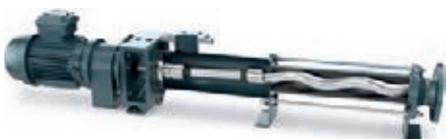
Abb. 3: Mit der Technologie der Exzentrerschneckenpumpe werden Medien kontinuierlich und pulsationsarm gefördert. Aufgrund dieser Eigenschaften kommen Nemo Exzentrerschneckenpumpen bevorzugt bei sensiblen Medien zum Einsatz.
