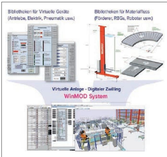
Abb. 4: Der digitale Zwilling entsteht durch Auswahl und Parametrierung von Virtuellen Geräten und 3D-Materialflusskomponenten aus technologiespezifischen Bibliotheken.
