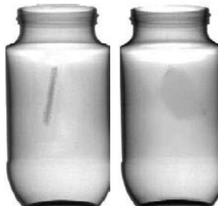
Abb. 3: Mit Hilfe der Doublebeam-Technologie erkennt Dymond D sogar Glasstücke in Glasgefäßen zuverlässig, unabhängig von ihrer Lage und Orientierung.
