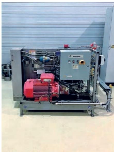
Abb. 3: Der Füllstand für das Schmieröl der Drehkolbenpumpen ist essentiell für Betrieb. Fällt dieser auf ein Minimum, wird eine sofortige Not-Abschaltung der Papiermaschine ausgelöst. Dank Vegapuls 64 wird nun der Füllstand sicher erfasst.
