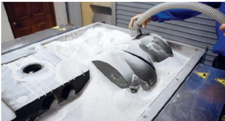
Abb. 2: Erstellen neuer Komponenten mit Sand für eine 3D-Druckform.
