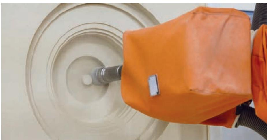
Abb. 3: Ein mehrachsiger CNC-Roboter kann präzise Formen und Kerne herstellen.
