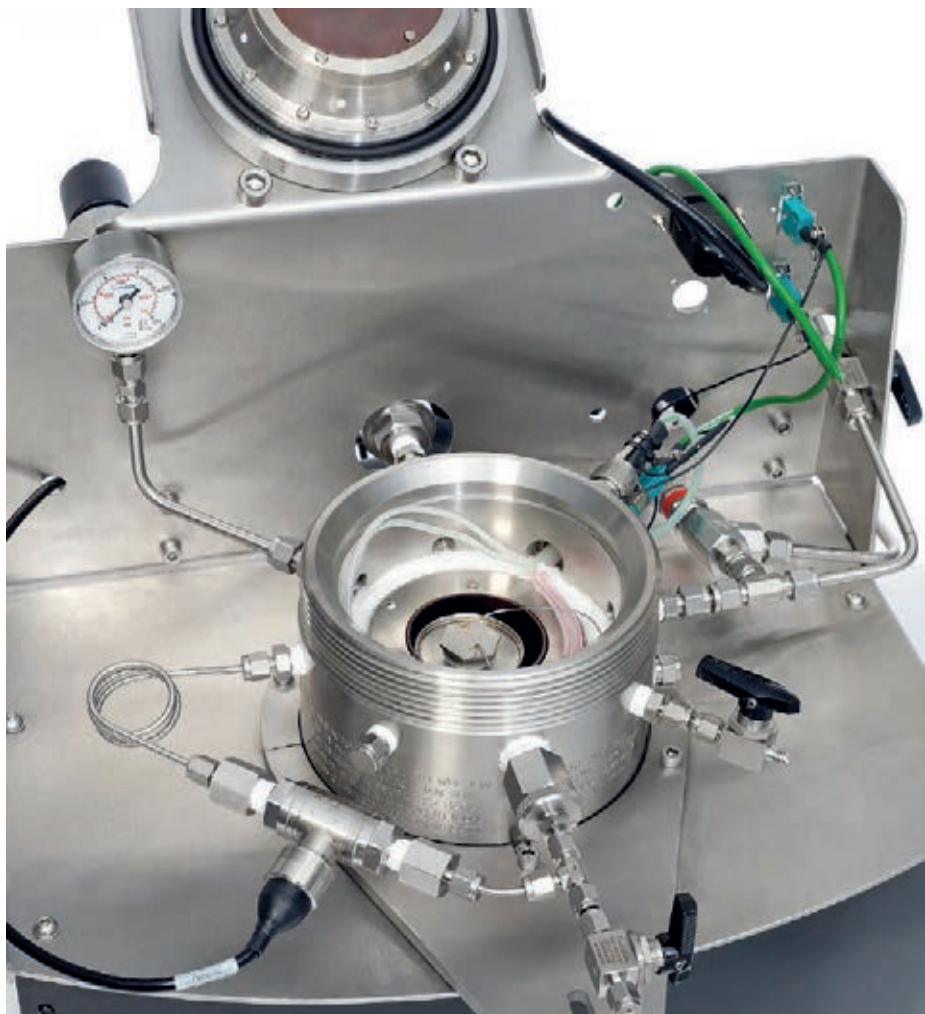
Abb. 1: Im Prozesssicherheitslabor von Jensen Hughes wird hauptsächlich das adiabatische Reaktionskalorimeter PHI-TEC II der britischen Firma HEL verwendet.
