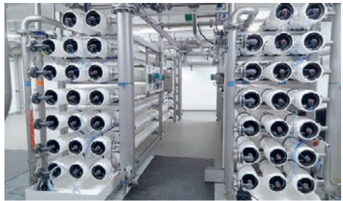
Abb. 1: Permeat-Monitoring-System für die kontinuierliche Einzeldruckrohr-Überwachung von Membrandefekten in Nanofiltrations- und Umkehrosmoseanlagen.
