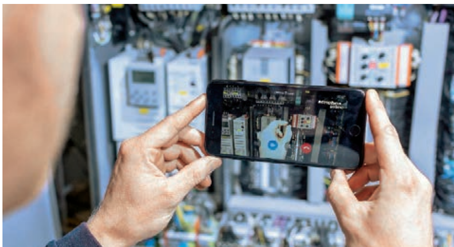
▲ Abb. 1: Über Hand-Overlay und Finger-Pointing kann der Minebea Intec Service-Techniker direkt konkrete Hilfestellungen geben.
