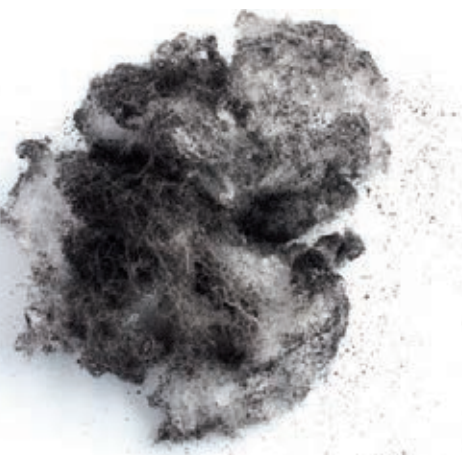
◀ Abb. 2: Ablagerung des Dämmstoffs aus Schalldämpfern mit Absorptionsmaterial
