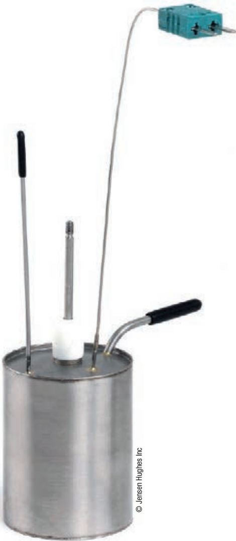
Abb. 2: Standardtestzelle für Versuche mit exothermischen Reaktionen
