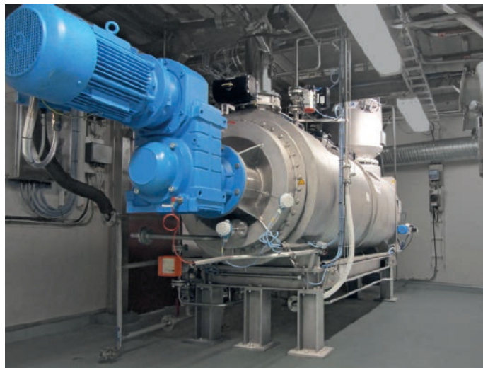
Abb. 1: Kontitrockner HTK-T für die Trocknung von Eigelbpulver
