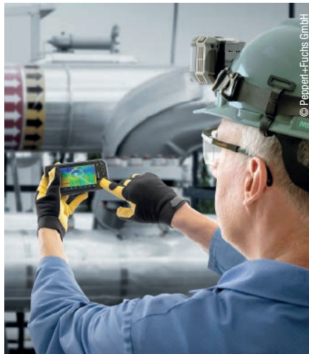
Abb. 2: Mitarbeiter betrachtet das Wärmebild aus dem Cube auf dem Ecom Smart-EX 01.
