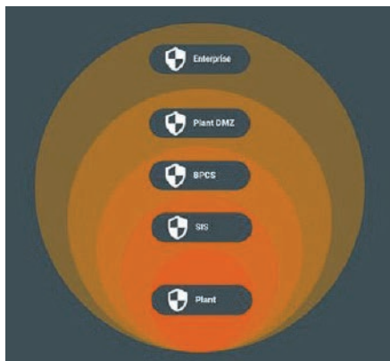
Abb. 1: Sowohl die Norm IEC 61511 (Safety) als auch die Norm IEC 62443 (Security) fordern den Aufbau mehrerer unabhängiger Schuttschichten.
