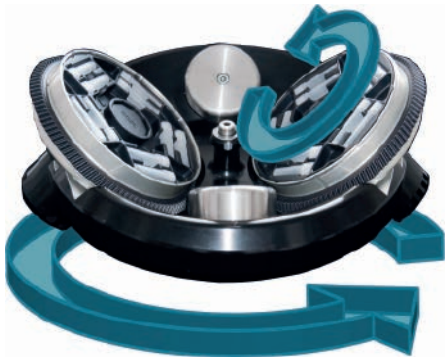
Abb. 2: Positionierung und Bewegungsablauf in der Dualen Zentrifuge DeltaVita 1.
