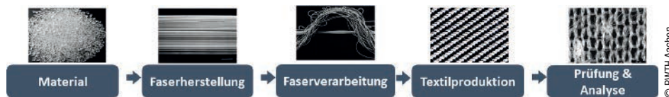
Abb. 4: Die textile Prozesskette wird am ITA komplett abgedeckt. Dazu stehen mehrere Schmelzspinnanlagen und ca. 250 Textilmaschinen und -prüfstände zur Verfügung.
