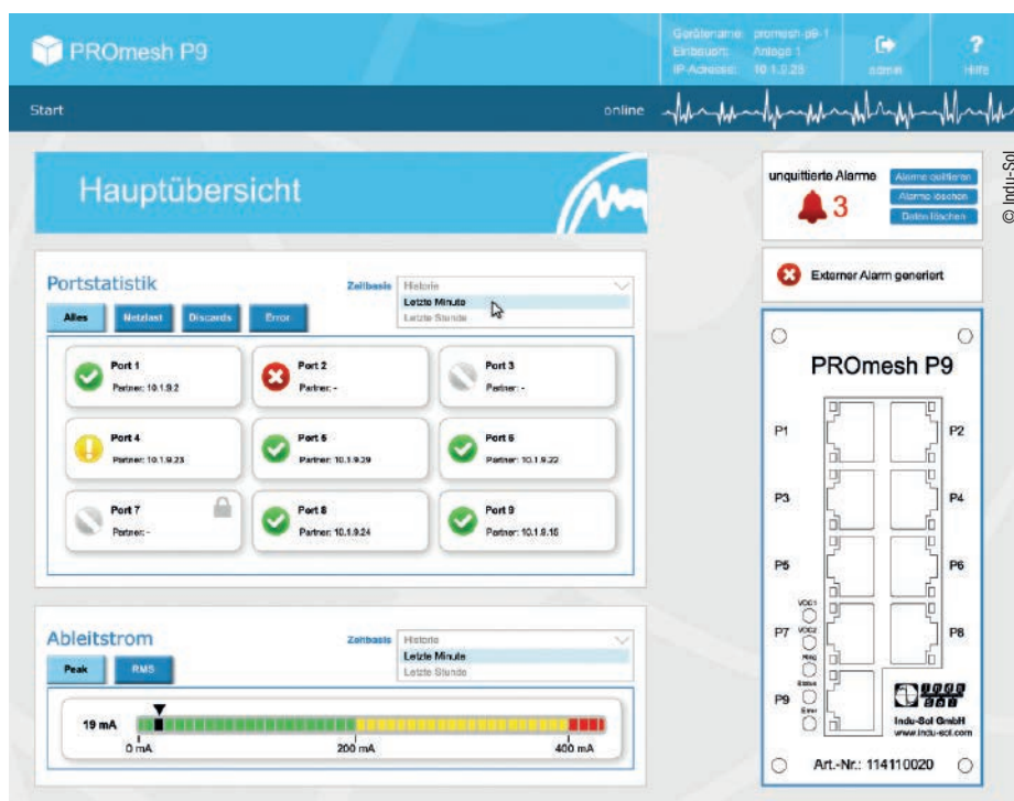
Abb. 4: Das übersichtliche Webinterface der PROmesh-Switches macht Portbelegung und -status direkt auf einen Blick sichtbar; mit wenigen Klicks lassen sich weitere Details darstellen.
