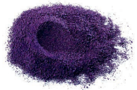
Abb. 3: In der langen Fertigungskette der Lithiumakkumulatoren stellt die Aufbereitung der Rohstoffe einen ersten, aber für die Qualität des Endproduktes mit entscheidenden Schritt dar. Die Kathoden heute üblicher Lithiumakkumulatoren bestehen im Wesentlichen aus einer Mischung aus Lithiumcarbonat und einem Nickel-Cobalt-Mangan-Mischoxid.
