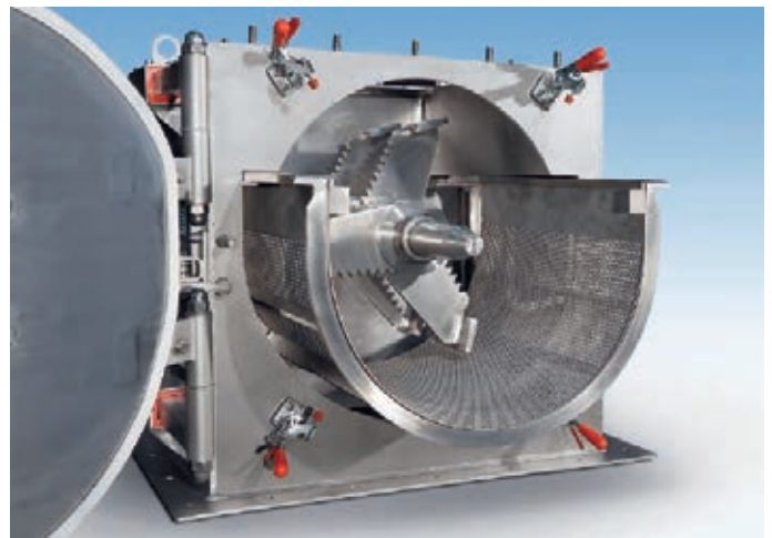
Abb. 2: Gezackte Klingen, die von einer rotierenden Welle abstehen, wischen Material gegen ein konturiertes Schleifsieb. Austauschbare Rotoren und Schleifsiebe, die auf einer ausziehbaren Halterung montiert sind, ermöglichen einen schnellen Zugang zur Reinigung.
