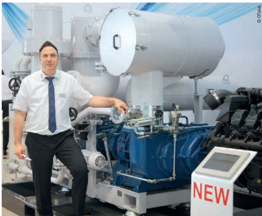
In Hannover präsentierte Sebastian Meißler die hochintegrierte Kombination eines öleingespritzten VMX-Schraubenverdichters mit einem direktgekuppelten CAT-Dieselmotor.
