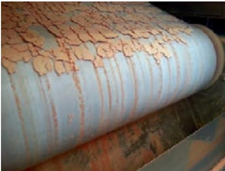
**Abb. 3:** Die Anlagen der EL-A Verfahrenstechnik GmbH sind in der Lage, sowohl fließfähige als auch weichpastöse, krümelige, kristalline oder stückige Stoffe zu trocknen
