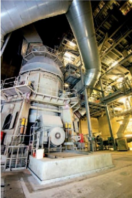
**Abb. 3:** Die Vertikalmühle zerkleinert das Mineralgemisch, bevor es in den Drehofen kommt.
