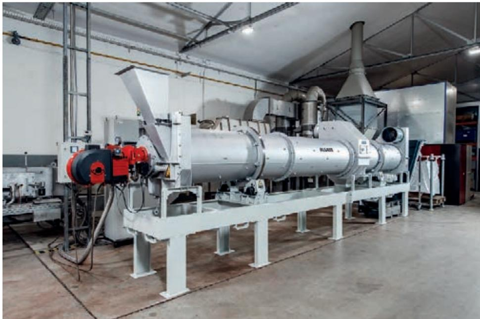
◀ **Abb. 1:** Die stets individuelle und aufgabenbezogene Fertigung der Trommeln ermöglicht ein sehr weites Einsatzspektrum für Durchsatzleistungen von 1 t/h bis über 350 t/h, sowie mit der Trocknung kombinierte Prozessschritte.
