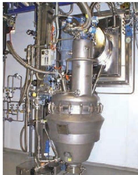
Abb. 2: Trockner mit Containment-System
