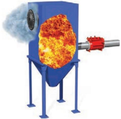
**Abb. 4: Berstscheibe zur Druckentlastung. Wenn es zu einer Explosion kommt, wird die Berstscheibe durch den Druckaufbau zerstört.**
