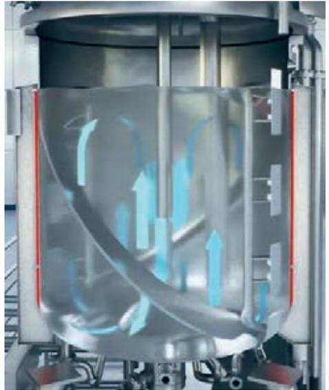
**Abb. 1:** Durch das intelligente Design des Paravisc Rührorgans werden, im Vergleich zu Koaxial- oder auch Kammschaukelrührorganen, Produktoberflächen minimiert und die Produktausbeute gesteigert.
