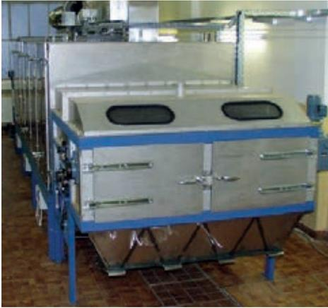
**Abb. 1:** Der Kontaktbandtrockner lässt sich aufgrund seiner ergonomischen Konstruktion einfach warten und sorgfältig reinigen.
