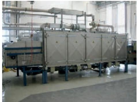
**Abb. 4:** Der Innenraum des Trockners ist über die Flügeltüren leicht zugänglich und gewährleistet schnelles sowie ergonomisches Arbeiten.
