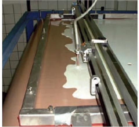
**Abb. 2:** Kontaktbandtrockner haben im Gegensatz zu anderen Trocknern keine Probleme, unterschiedliche Stoffarten zu verarbeiten.
