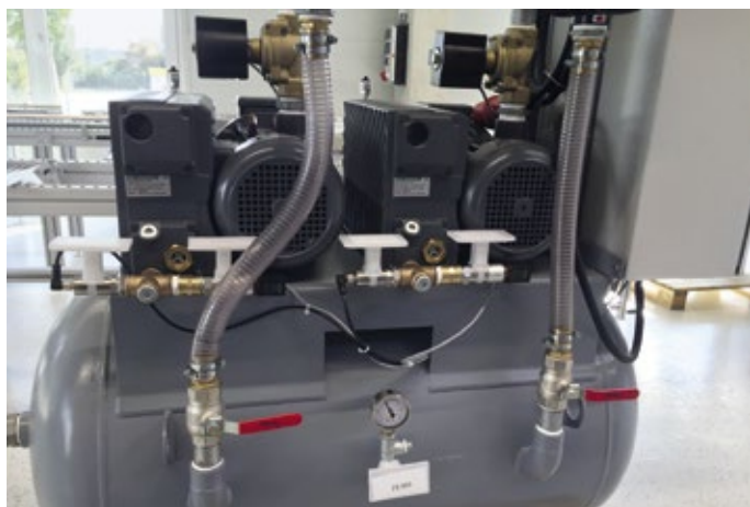
Abb. 8: ZMD Vakuumsystem mit Sensoren für das Predictive Maintenance.
