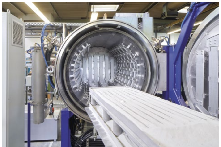
Abb. 1: Mit einem Schmelzpunkt bei 3.400 °C lassen sich mit Wolfram im Hochtemperaturofen bis zu 2.800 °C erreichen, wobei das Material formstabil, korrosionsbeständig, kriechfest und langlebig ist.
