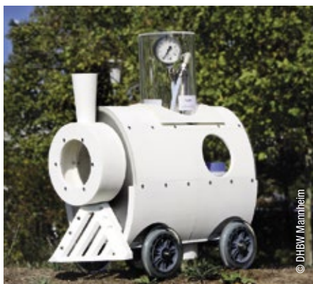
Abb. 4: Das Team der DHBW Mannheim ging mit der LoChemotive an den Start. Die mit Chemie betriebene Lokomotive besitzt ein 3D-gedrucktes Chassis und nutzt die katalytische Zersetzung von Wasserstoffperoxid als Antrieb.
