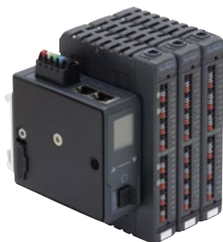
Abb. 1: Zwei neue Komponenten, das I/O-Modul ME44 und das Feldbus-Gateway ME43, erweitern nun die Plattform.
