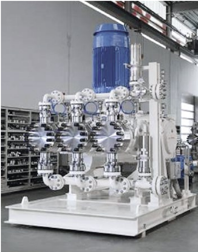
Abb. 3: Pumpen-Konstruktionen, wie sie Lewa produziert, entsprechen dem API675-Standard für prozesssicheres Fördern von brennbaren, toxischen, feststoffbeladenen oder hoch viskosen Fluiden und besitzen keine dynamischen Dichtungen.
