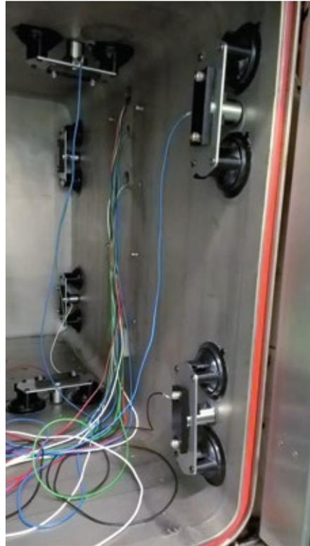
**Abb. 2:** Kabeldurchführungen und Schallemissionsensoren in Vakuumhaltern in einer Sterilisierkammerwand.
