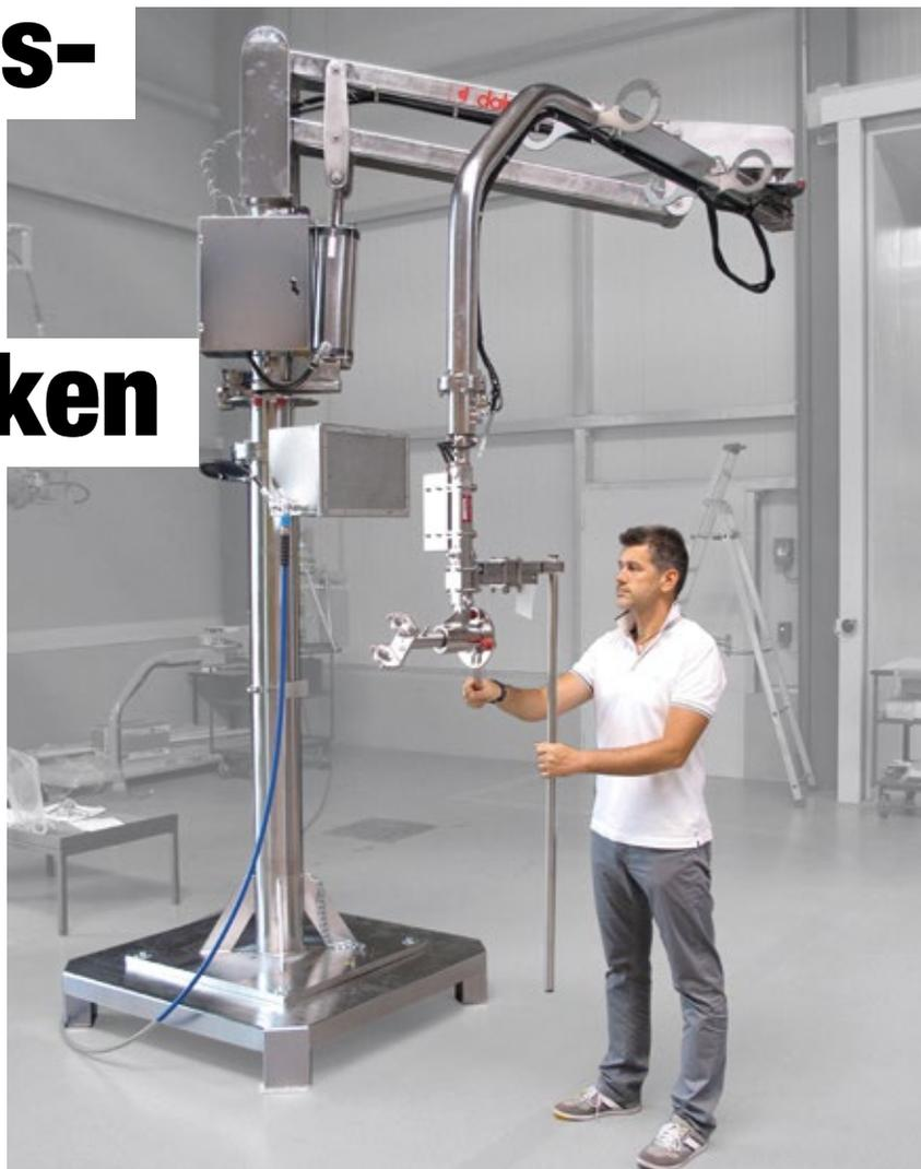
Manipulatoren des Typs PARTNER und die dazugehörigen Aufnahmevorrichtungen können entsprechend den Anforderungen der Reinheitsklassen in Lebensmittel-, pharmazeutischer und chemischer Industrie sowie in sterilen Bereichen komplett in Edelstahl gefertigt werden. © Dalmecc GmbH
