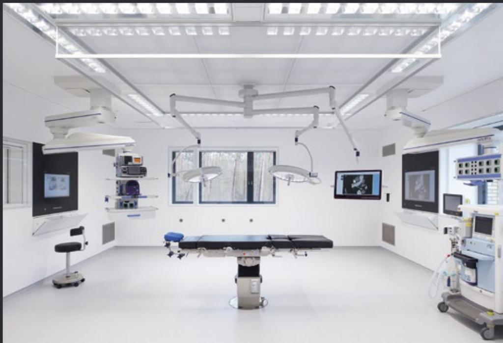
**Die Ib-OPs sind mit TAV-Feldern und Tageslichtfenstern mit belüfteter Fassadenverkleidung ausgestattet.**
