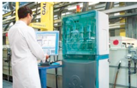
Abb. 1: Vollautomatischer Prozessanalysator an Ort und Stelle: In der Prozessumgebung erhält der Mitarbeiter eine umfassende Unterstützung. © Metrohm
