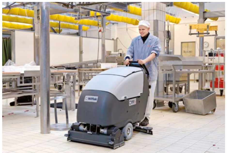
Abb. 2: Abhängig vom Bodenbelag sollte das Bürstendeck gewählt werden. Zylinderbürsten sind für unebene Böden und zur Reinigung von Fugen die erste Wahl (Modell: Mitgänger-Scheuersaugmaschine BA751C).
