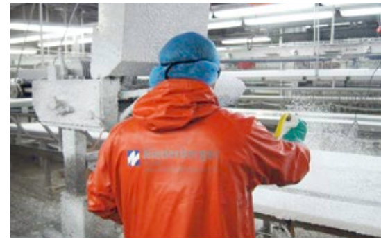
Abb. 2: Bei Transportbändern, Frostern und im Zerlegebereich kommt die Schaumreinigung zum Einsatz. Die zerplatzenden Schaumbläschen sorgen für kontinuierlichen Nachschub an Reinigungsflüssigkeit.
