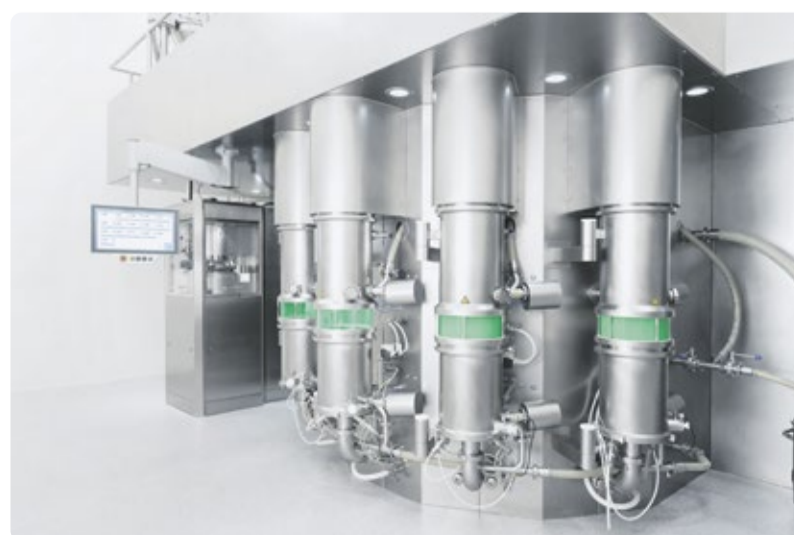
Bei der auf Minibatches basierenden kontinuierlichen Herstellung werden einzelne Pakete, sogenannte X-Keys, absatzweise dosiert, gemischt und granuliert.
