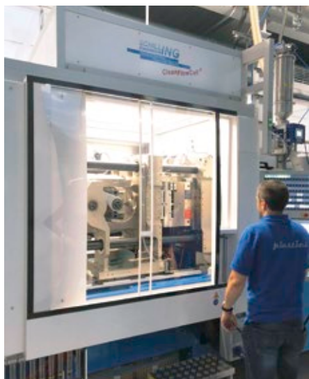
Abb. 1: Eine Einhausung mit Laminar-Flow-Aufsatz spült das Produkt schon während des Spritzgussprozesses mit Reinstluft
