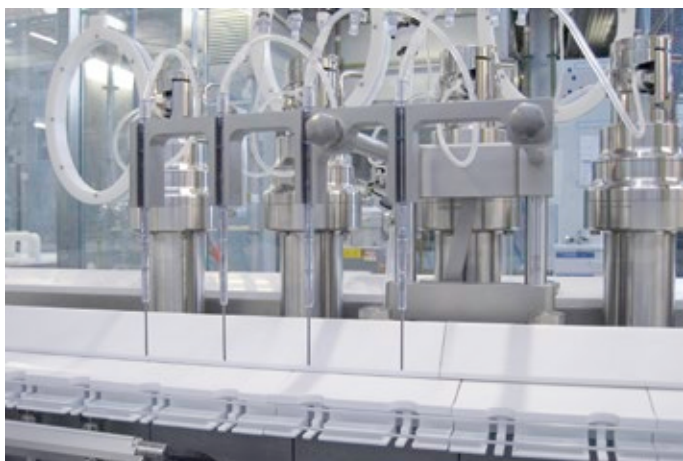
Abb. 1: Die MLF 5044 Füll- und Verschließmaschine für Vials arbeitet mit einer Peristaltikpumpe und 100 % In-Prozess-Kontrolle.
