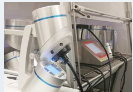
Abb. 3: Experimenteller Aufbau zum Test des HEPA Filters auf dem Luftkeimsammler MAS-100 NT. Das Instrument steht in der unkontrollierten Referenzumgebung ausserhalb der Biosicherheitswerkbank.
