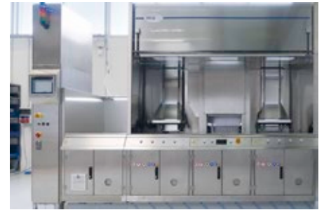
Abb. 1: Die Anlage für die Reinigung von Warenträgern verfügt über zwei Reinigungs- und eine Trockenstation. Sie wird in einen Reinraum integriert.
