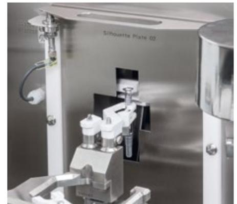
Abb. 3: Für die sichere und flexible Übergabe in unterschiedliche Anlagenzonen: Der „Specht“ genannte Übergaberoboter erfüllt dabei alle Kriterien des „aseptic processing“. © OPTIMA packaging group
