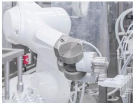
Abb. 2: Der hochflexible Transport unterschiedlicher Formate und Behältnistypen gelingt bestmöglich mit einem roboterbasierten System. © OPTIMA packaging group
