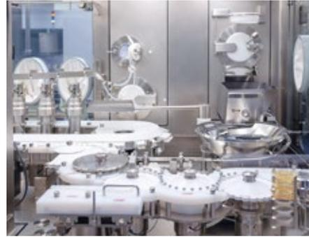
**Abb. 4: Kontinuierlich arbeitende Stopfensetzstation mit Kamerasystem**
