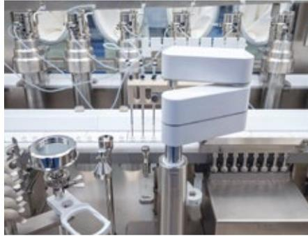
**Abb. 3: Abfüllanlage mit 100 % IPK und integriertem Dosiersystem**
