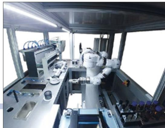
**Abb. 3: In einem aktuellen Entwicklungsprojekt werden mit dem CSDA10F etwa ein Dutzend Prozesse für die vollautomatische Produktion von Nanopartikeln verkettet ausgeführt.** © Goldfuss Engineering GmbH
