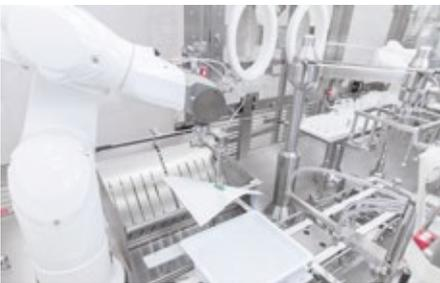
Abb. 1: Tyvek-Removal-Roboter: Das pharmazeutische Unternehmen hat hier den Vorteil eines durchgängigen Systems in der Anlage. © OPTIMA packaging group
