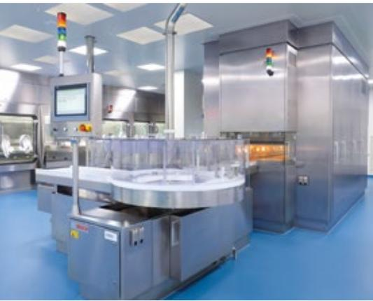
**Abb. 6: Isolator-Abfülllinie für gefriergetrocknete Substanzen**
