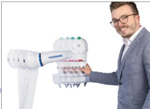
**Abb. 2: Für die Teil-Automatisierung von Handlingaufgaben ist ein kollaborativer Roboter erforderlich, der im direkten Kontakt mit dem Menschen eingesetzt werden kann.** © Yaskawa
