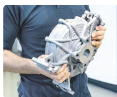
Der 3D-Druck macht es möglich: Pumpengehäuse wie diese sind mit klassischen Fertigungsmethoden nicht herstellbar.
