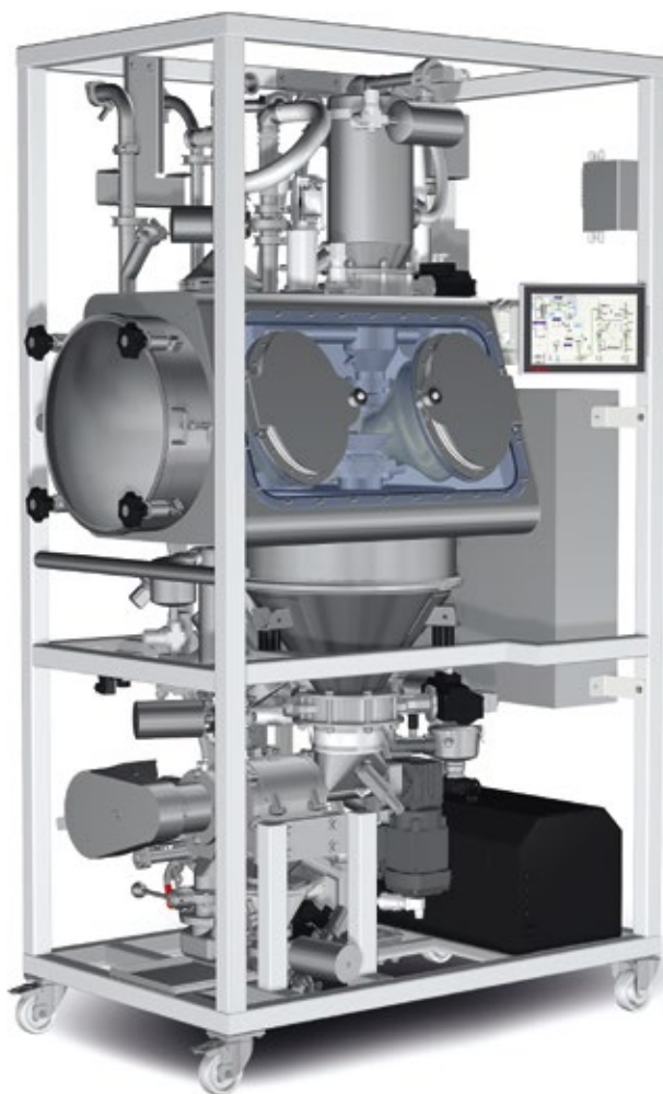
Abb. 3: 3D-Drucker-Beschickungsmodul und Glovebox: Einschleusung des Metallpulvers
