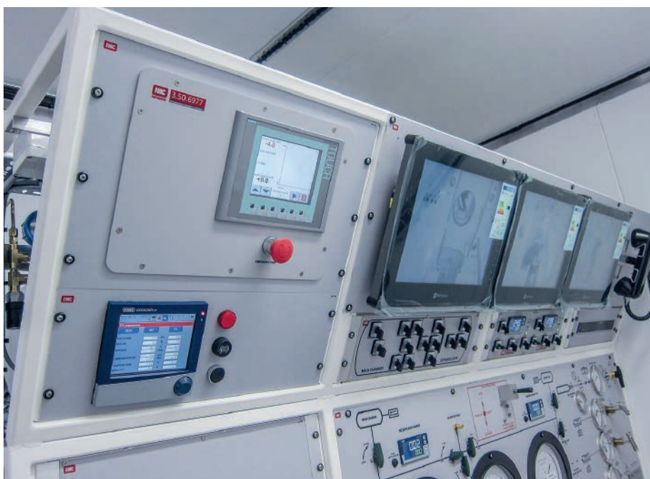
Abb. 2: Das Steuer- und Überwachungspult einer Dekompressionskammer
