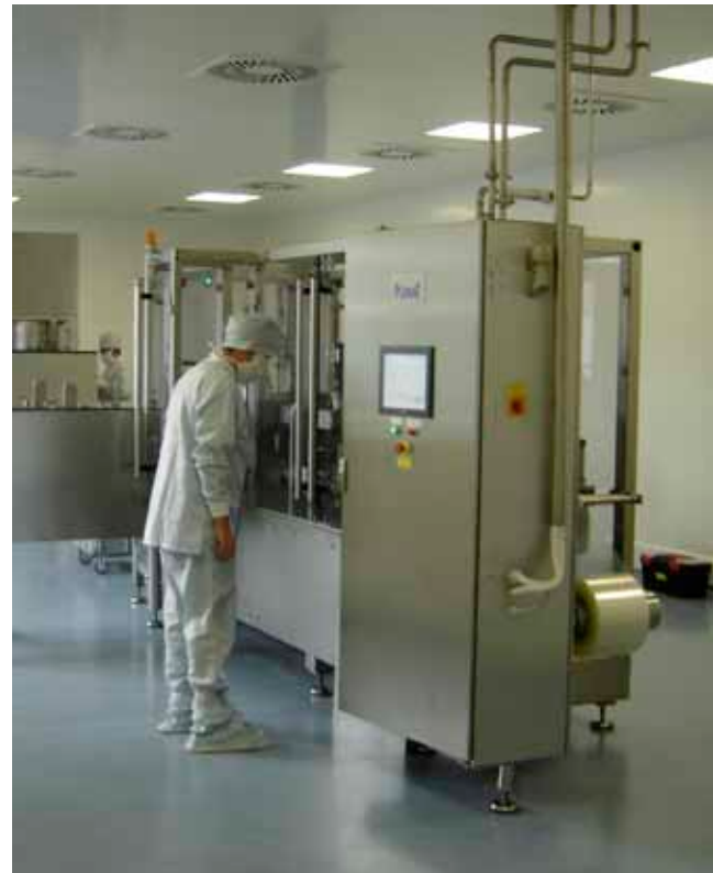
Ansatzbehälter im Reinraum der Infusionslösungsanlage... ... sowie die Infusionsbeutelherstell- und -füllmaschine in Almaty
