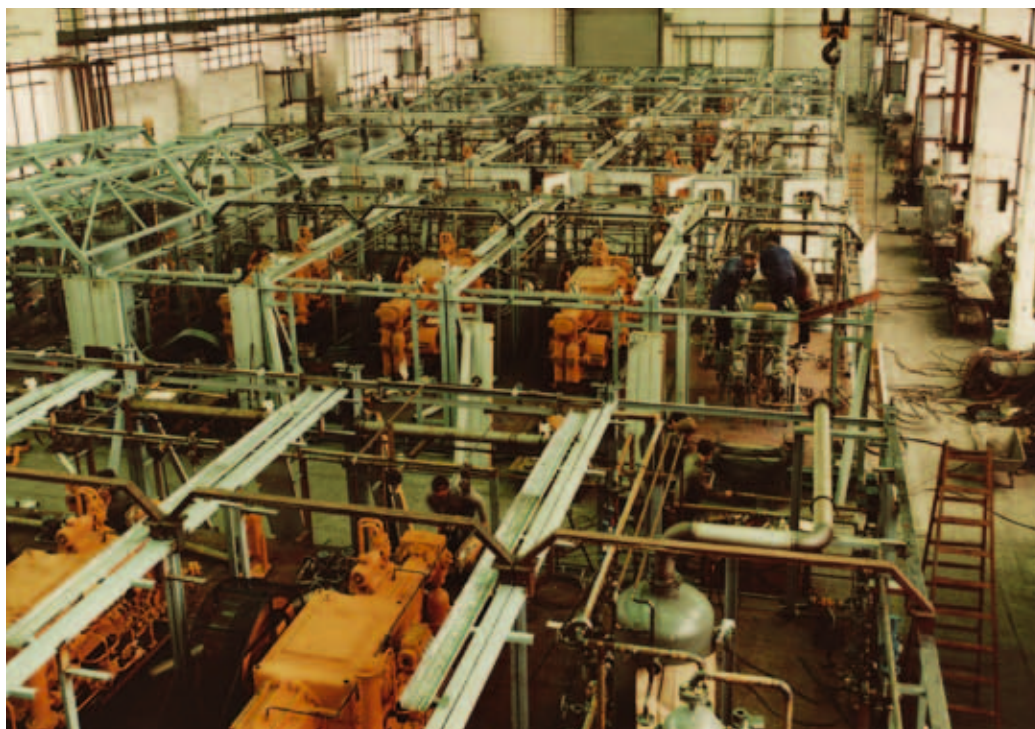
Fertigung von Erdgastankstellen in Serienproduktion
