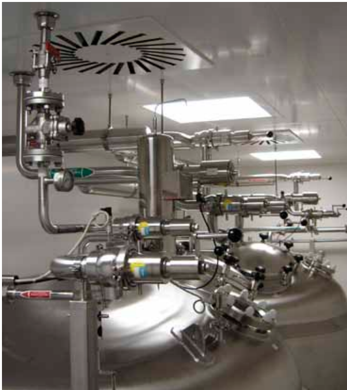
Ansatzbehälter im Reinraum der Infusionslösungsanlage... ... sowie die Infusionsbeutelherstell- und -füllmaschine in Almaty
