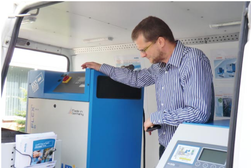
Abb. 4: Michael Wegener demonstriert den Betrieb eines Kompressors mit variabler Drehzahl.
