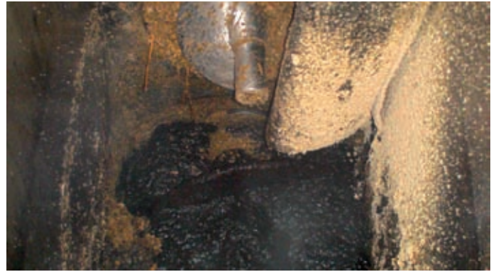
Abb. 2: Bei der Nemo B.Max Mischpumpe findet die Vermischung von flüssiger Phase und trockenem Substrat bereits im Trichterraum statt. Dadurch lässt sich eine erhöhte Gasausbeute erzielen.
