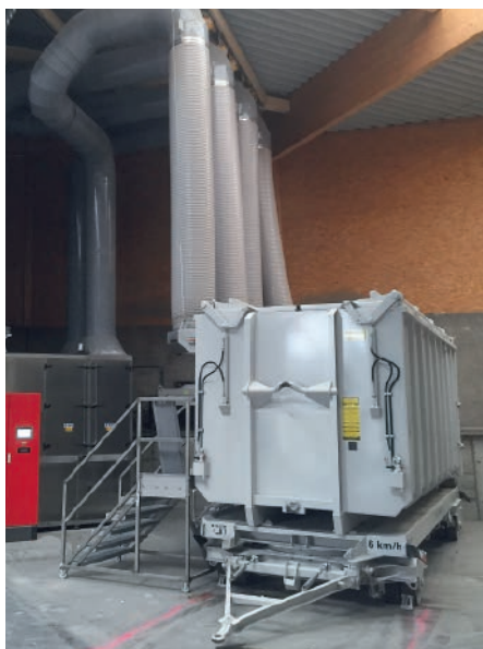
Abb. 2: Der Transportcontainer mit einem Nutzvolumen von 22 m 3 dient gleichzeitig zur Trocknung. Während der Trocknung ist er mit dem Entfeuchtungsmodul verbunden.
