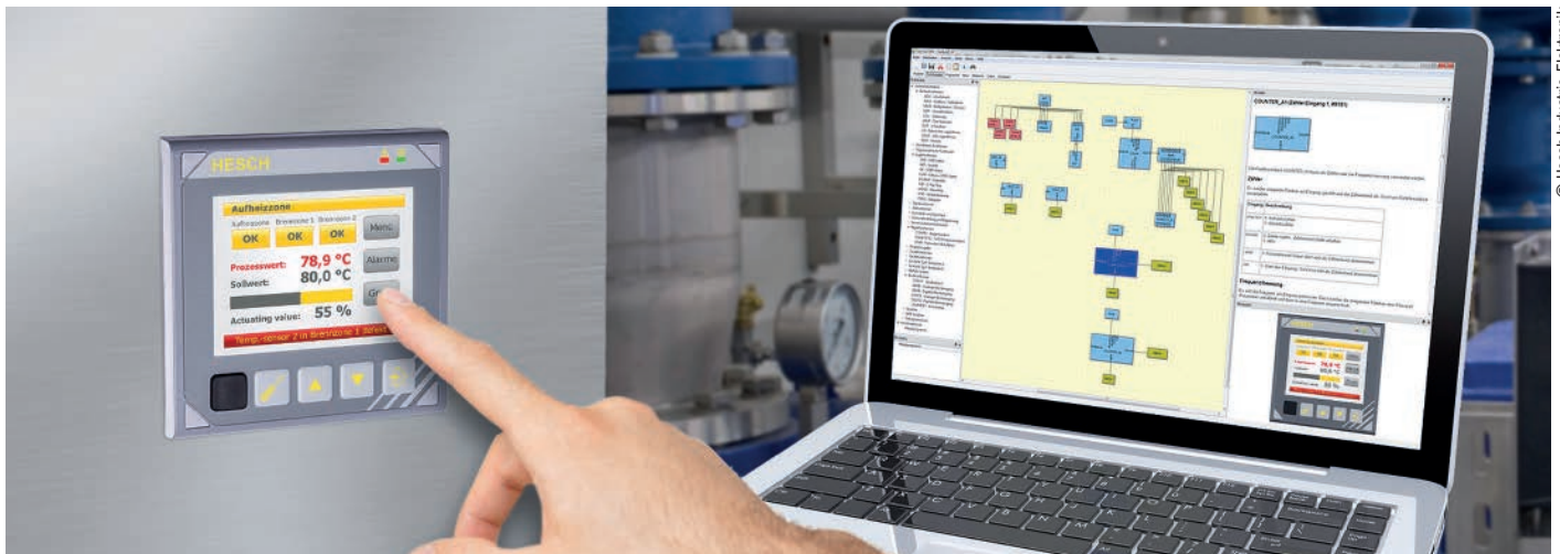
Abb. 2: Die Bedienung des MFC erfolgt über ein resistives 3,5-Zoll-Touch-Display
