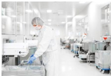
Abb. 3: Ein Blick in die Reinraumproduktion gemäß ISO 14644-1 (Klasse 7)
