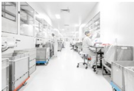
Abb. 2: Ein Blick in die Reinraumproduktion gemäß ISO 14644-1 (Klasse 7)
