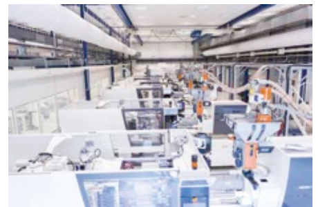
Abb. 1: Die vollelektrischen Spritzgießmaschinen sind direkt an den Reinräumen der ISO Klasse 7 angeordnet.
