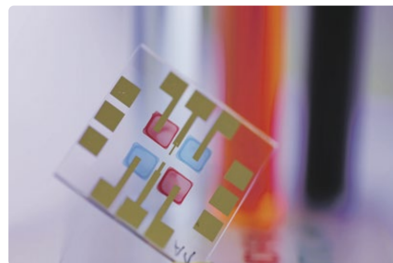
Organische Lichtsensoren mit farbselektiver Detektion, die durch Tintenstrahldruck mit halbleitenden Tinten hergestellt werden.
