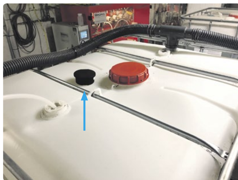
Die Smart Cap wird mit nur wenigen Handgriffen am IBC der Firma Servophil angebracht.
