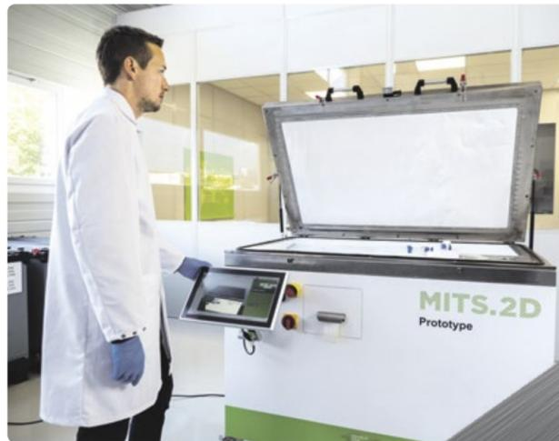
Es gibt ein eigens entwickeltes Testsystem, mit dem Single Use Bags auf Dichtigkeit geprüft werden können.
