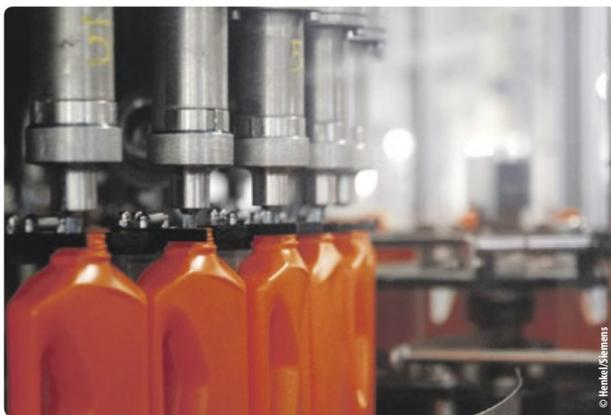
Bei der Abfüllung von Reinigungsmittel in die Flaschen werden die korrekte Füllmenge sowie der Fülldruck automatisch überwacht.
