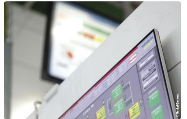
Via Dashboard werden die Betriebszustände der Maschinen sowie die Gesamtperformance von Abfüllung und Verpackung direkt an der Produktionslinie visualisiert.
