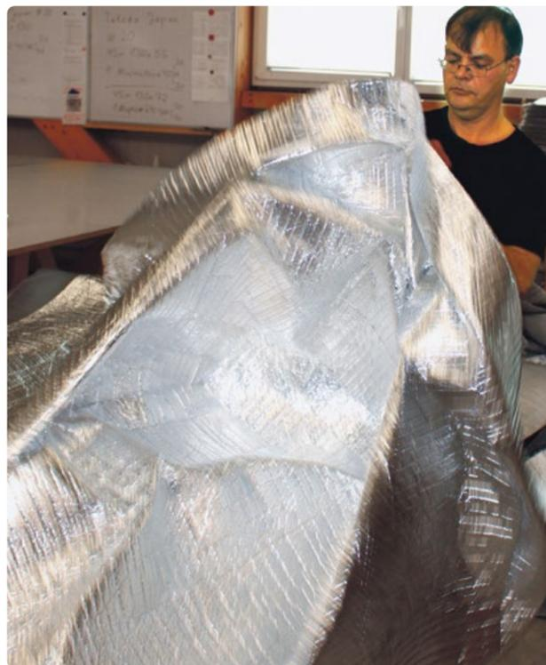
Ein Mitarbeiter von Ecocool stülpt die Thermohauben nach der Fertigung an der Nähmaschine um.
