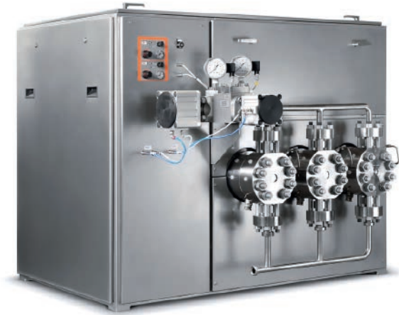
Abb. 2: Da dem UHT-Verfahren nachgeschaltete Homogenisatoren die Lebensmittel nicht rekontaminieren dürfen, müssen Hochdruckmembranpumpen verwendet werden.
