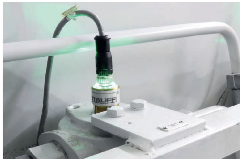
Abb. 2: Der Verschmutzungsanzeiger HI-D024 von Stauff vereinfacht die Kontrolle des Verschmutzungszustands von Filterelementen.
