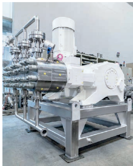
Abb. 4: Der Zweck der Pumpe besteht darin, die Energie für die Dispergierung im Homogenisationsventil aufzubringen, das zu dispergierende Fluid zu transportieren und für die genaue Fördermenge im Prozess zu sorgen.
