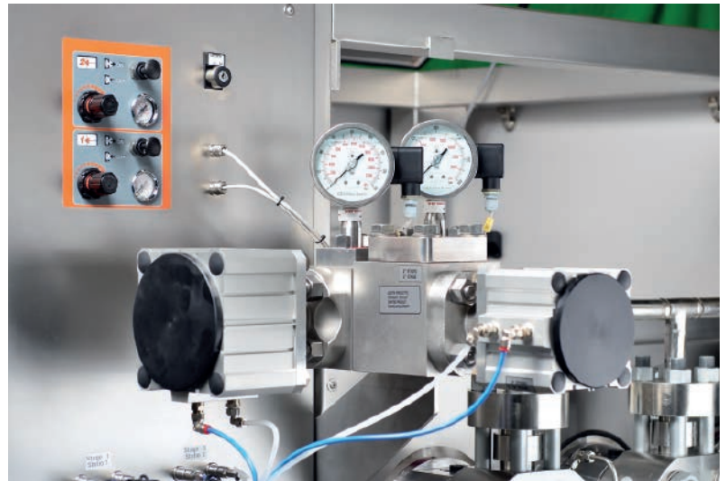
Abb. 3: Hochdruckhomogenisierer bestehen neben einer Pumpe als Druckerzeuger auch aus einem hydraulischen Verbraucher, dem sogenannten Homogenisationsventil.
