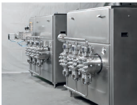
Abb. 5: Homogenisatorpumpen verfügen über drei bis sechs Pumpenköpfe.
