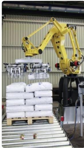
Die Baureihe Beumer Robotpac palettiert und depalettiert mit spezifisch entwickelten Greifsystemen unterschiedlichste Packstücke.
