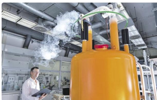
Gigant mit Feingefühl: Mit knapp 2,5 m Höhe und einem Gewicht von 850 kg ist das NMR-Spektrometer auch optisch äußerst imposant.
