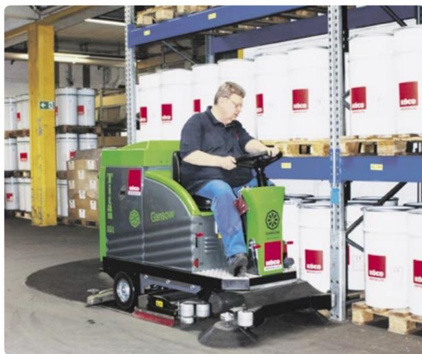
Das selbstnivellierende elektromechanische System der Titan 151 BF 75 Sweep garantiert, dass die Walzen stets perfekt auf dem Boden aufliegen.
