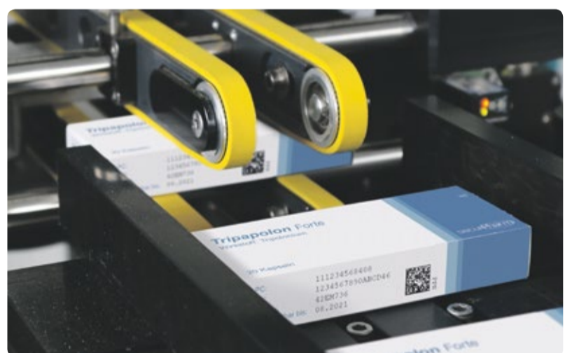
Packung mit Data Matrix Code (DMC) aus der Produktionslinie kommend. Die Darstellung ist konform zum Heilmittelwerbegesetz und den Securpharm-Codierregeln.
