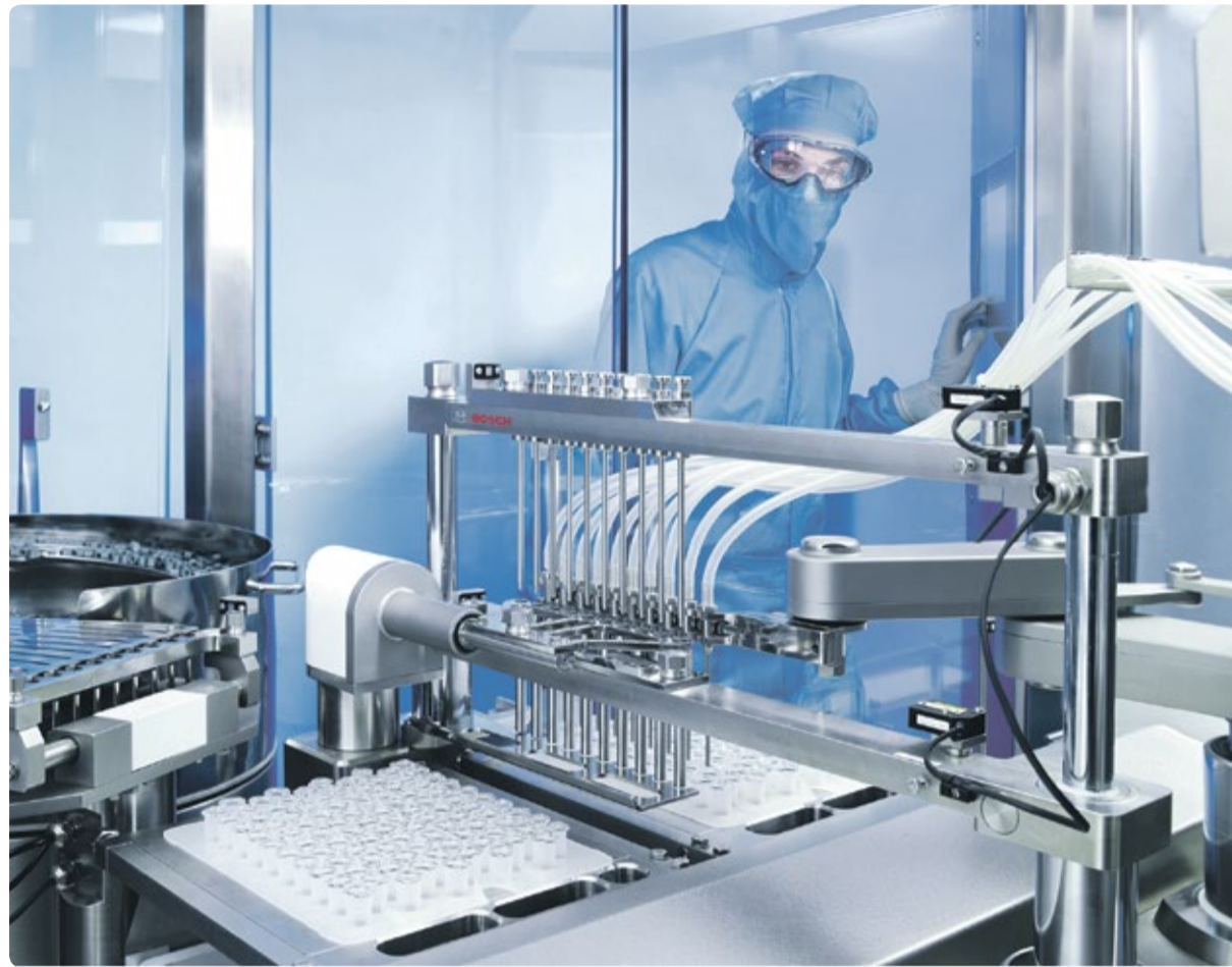
Um Mensch und Produkt effektiv voneinander zu schützen, wächst auch der Bedarf an geschlossenen Barriersystemen. Mit hermetisch geschlossenen Systemen von Bosch sind Bediener und Prozessbereich vollständig voneinander getrennt.
