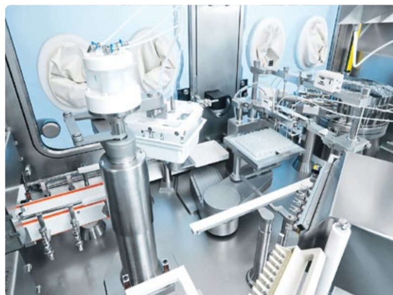
Durch spezielle Druckzonenkonzepte kann die potenziell kontaminierte Luft aus dem kritischen Füll- und Verschleißbereich nicht entweichen. Rückluftfilter für aseptisch-hochpotente Isolatoranwendungen filtern die Abluft und unterbinden damit die Verschleppung hochpotenter Aerosole.
