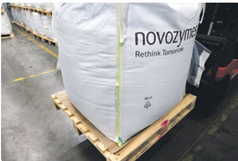
Der Antim-Antirutschbogen fungiert als Transportsicherung und verringert effektiv das Risiko, dass die Säcke während des Transports von der Palette gleiten.
