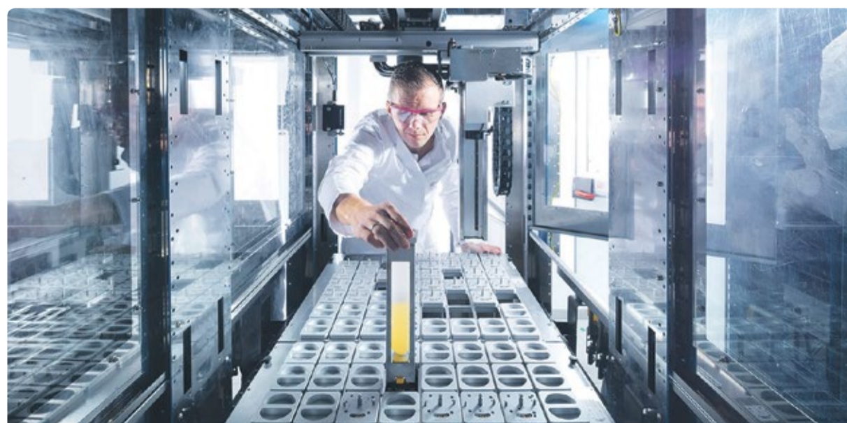
F&E beschleunigen: Die neue Hochdurchsatzanlage von Evonik kann 120 Proben am Tag formulieren und testen.
