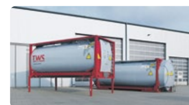
Kombination aus Tankcontainer und Leckagewanne bietet TWS nun an.
