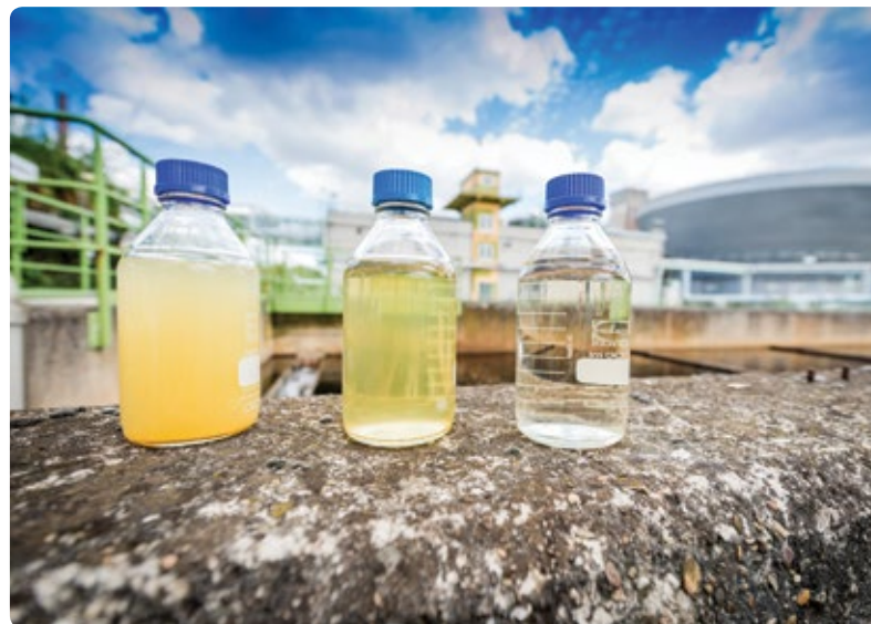
Trüb, klar, sauber: Die verschiedenen Reinigungsstufen des Abwassers, das die Abwasserreinigungsanlage durchläuft.
